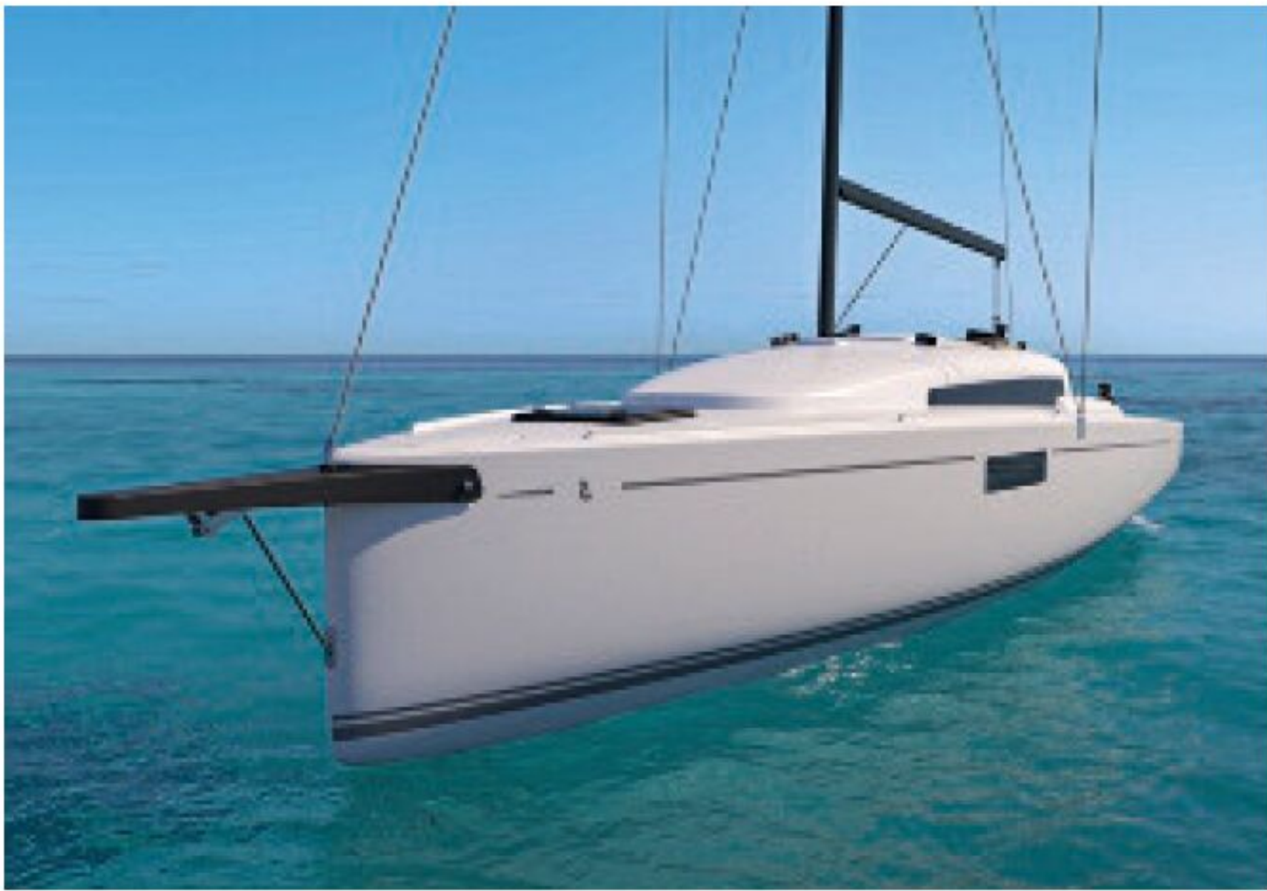
Der Bugspriet ragt fast einen Meter über den Rumpf hinaus und trägt auch den Anker
