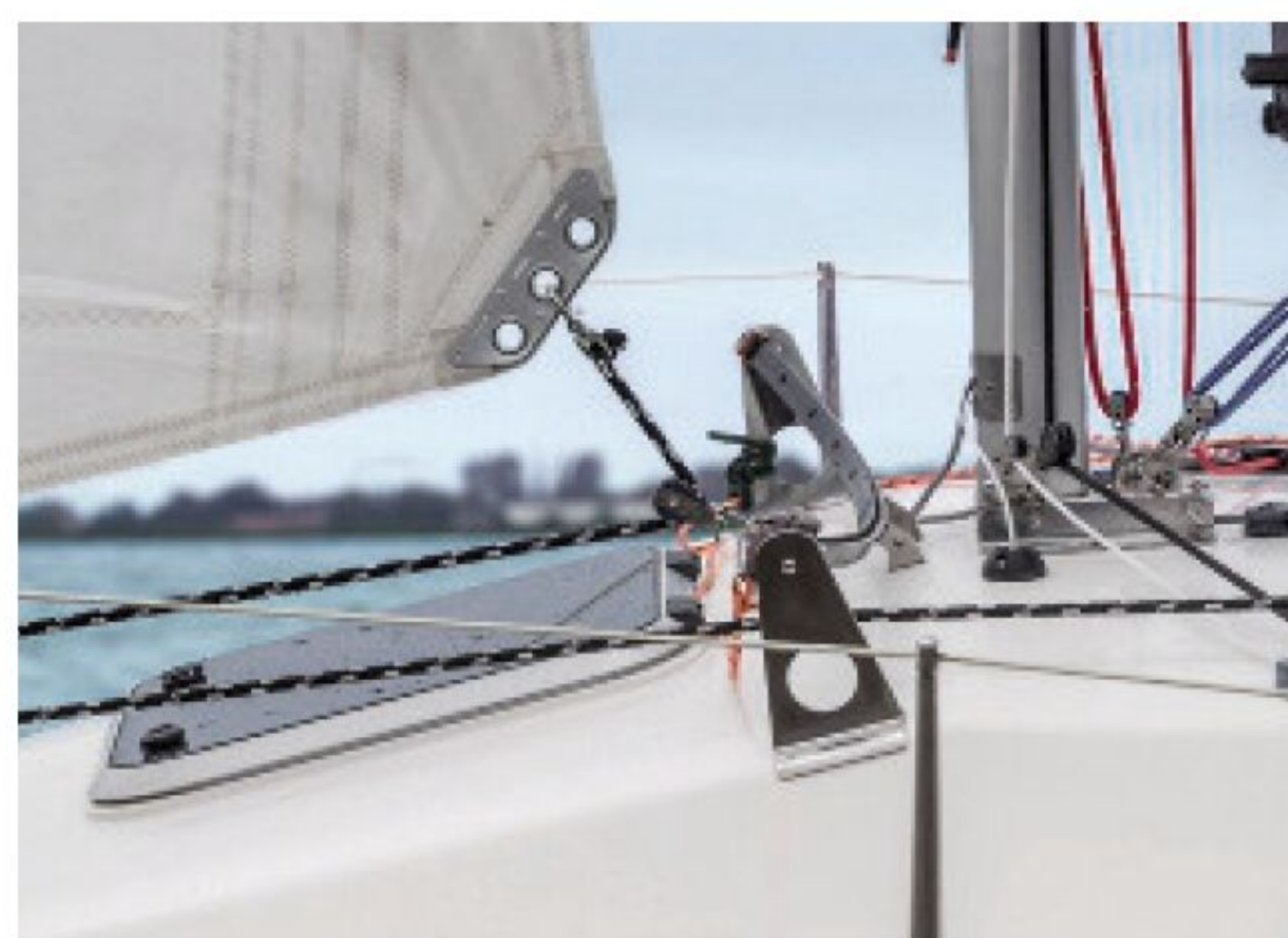
Die Selbstwendefock ist Standard, Genuaschienen gibt es auch auf dem Kajütdach
