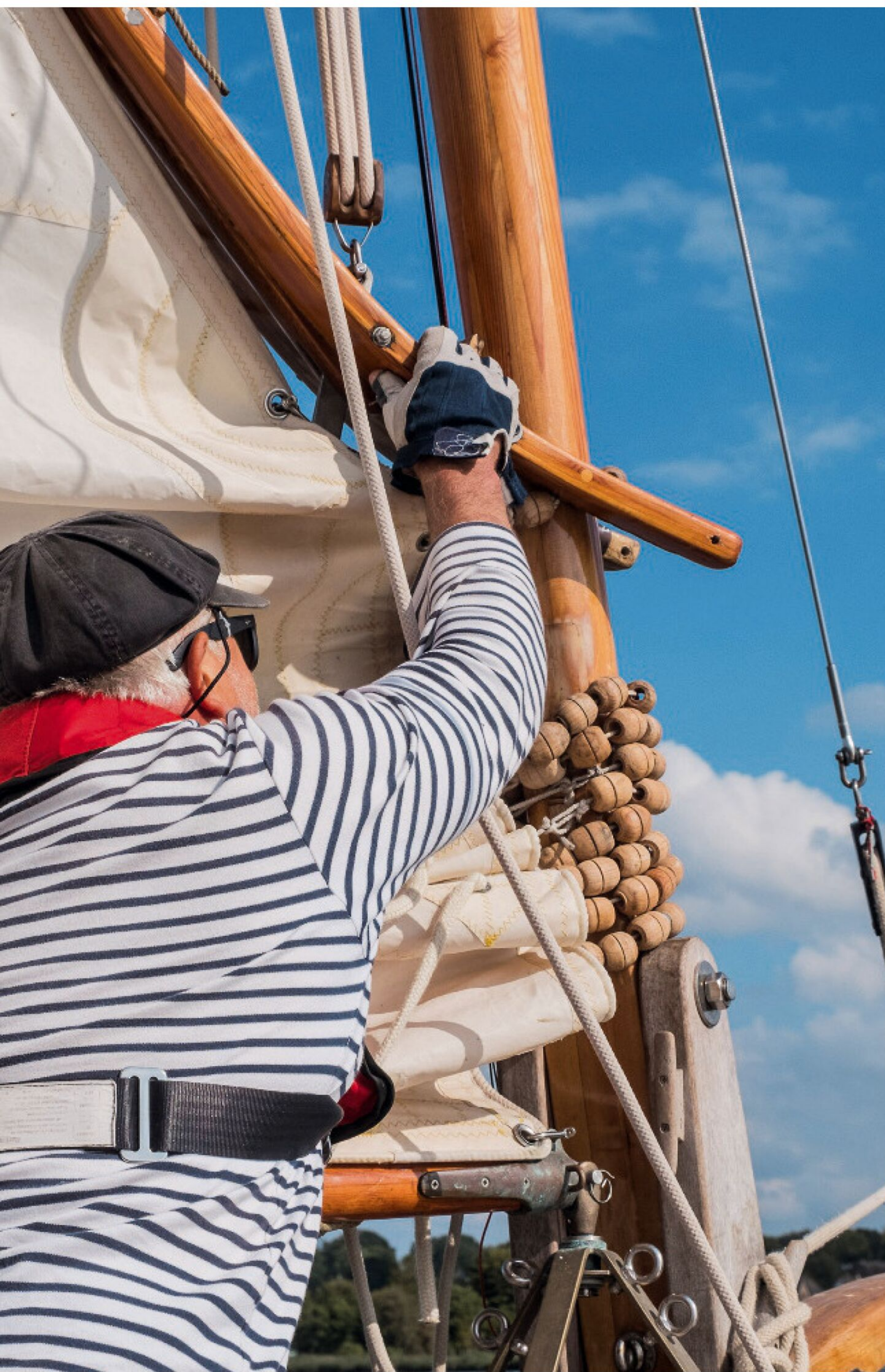
Frank Telwest beim Segelbergen auf seiner „Fortuna“. Das typische Gaffelsegel wird mit Reihleine und Rollen am Mast gefahren, der steht an Deck und ist unkompliziert klappbar
