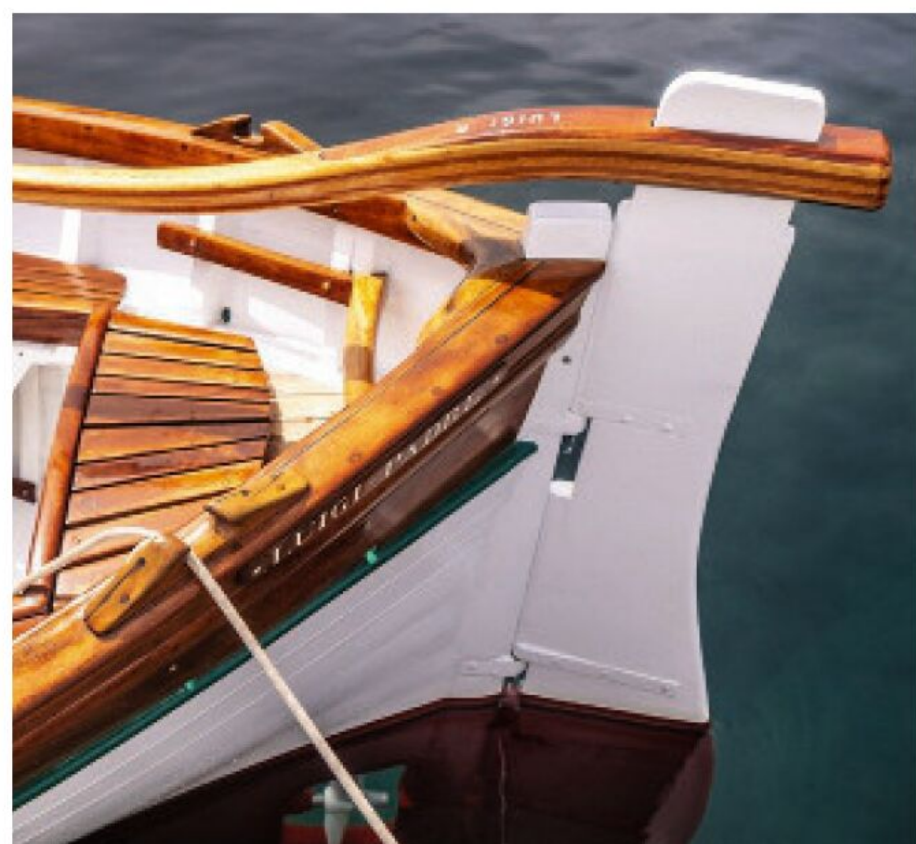
Der Propeller sitzt fast direkt vor dem angehängten Ruderblatt mit der stilvollen Pinne
