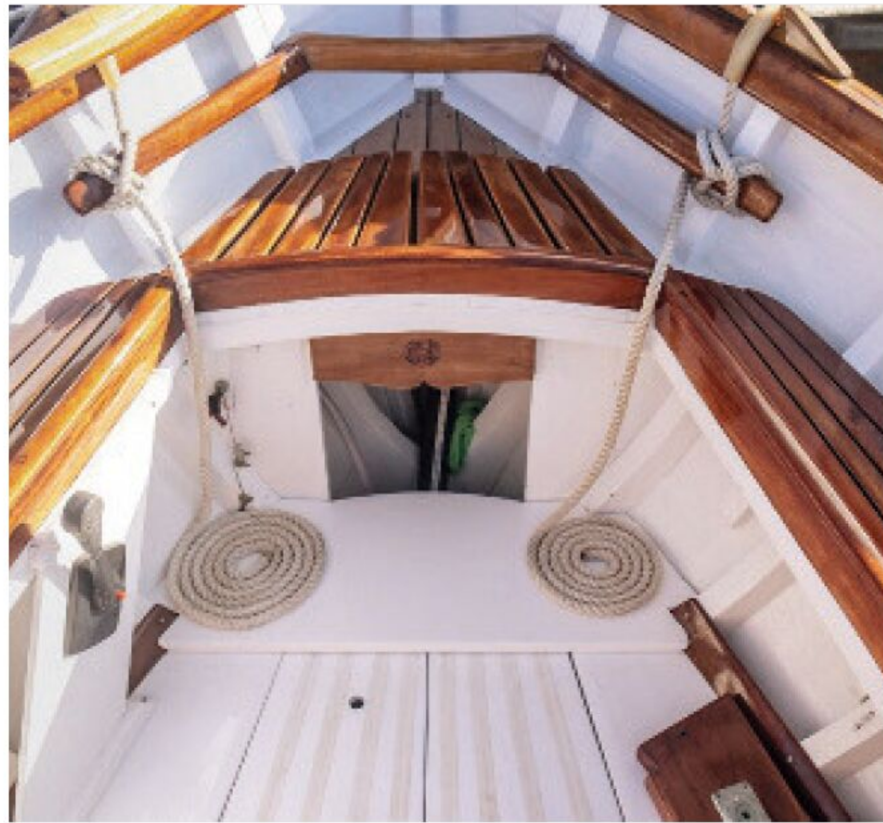
Gediegen: Das Boot ist aus peruanischem Mahagoni gebaut und teils klar lackiert
