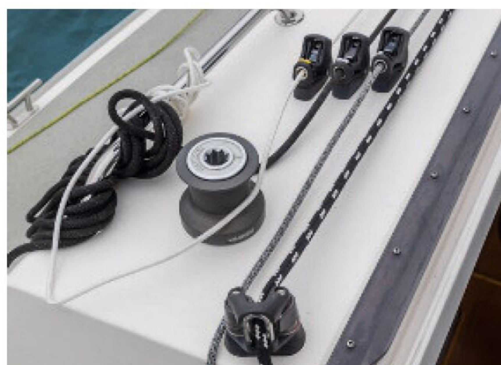
Umgelenkt: Die Leinen vom Mast führen ins Cockpit, wo die Arbeitshöhe ideal ist
