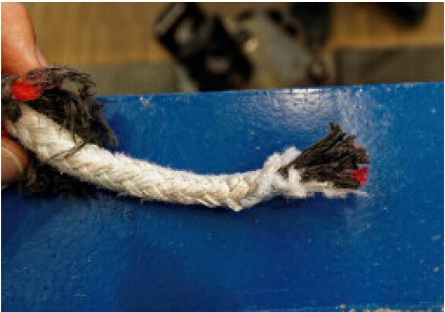
Die Leinen brechen meist hinter dem Spleiß, erreichen aber gute Bruchlasten
