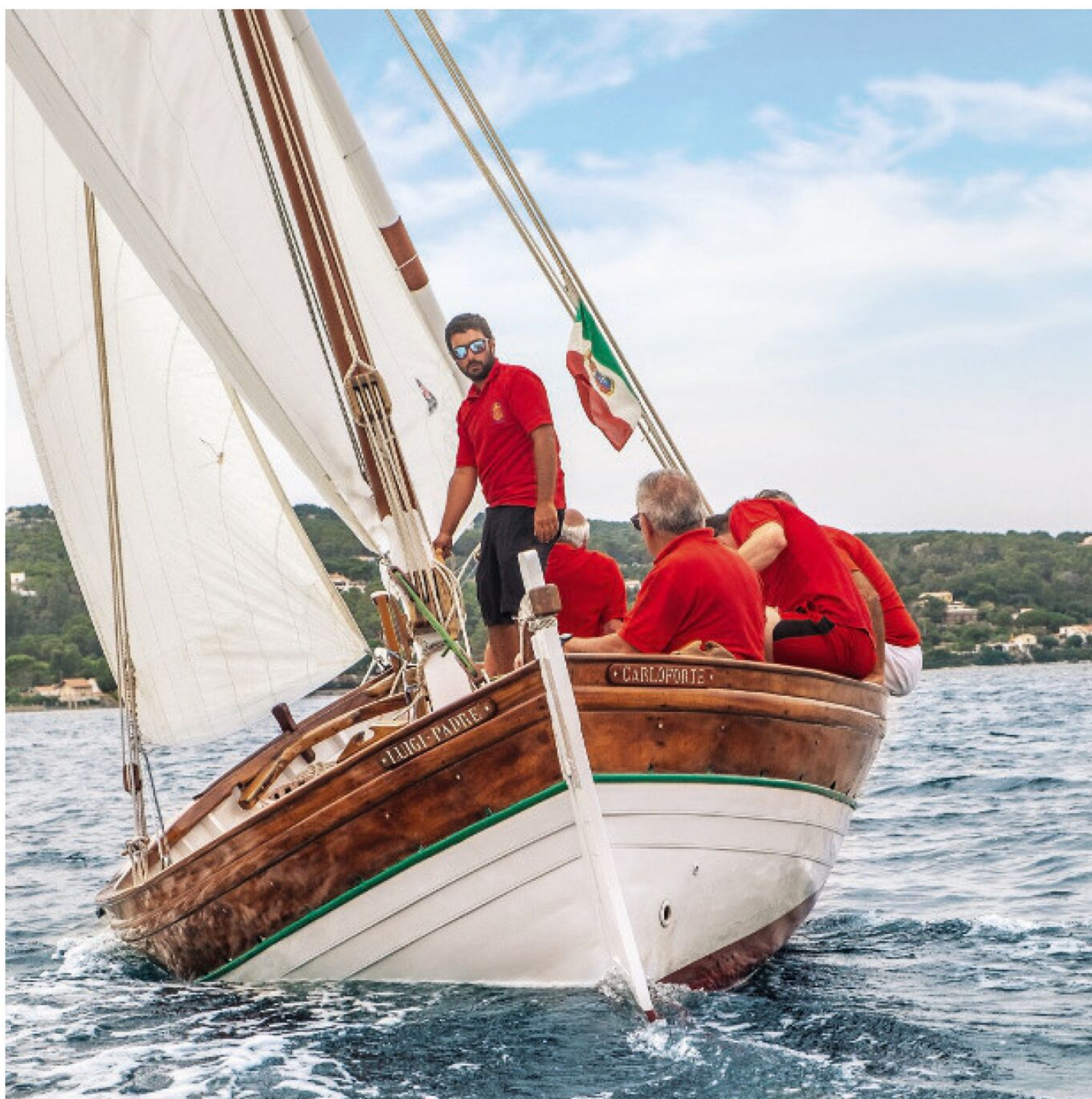
Die Spantform der historischen Gozzos mit der schmalen Wasserlinie und dem ausladenden Freibord steht für gute Segeleigenschaften auch bei wenig Wind und eine gute Formstabilität
