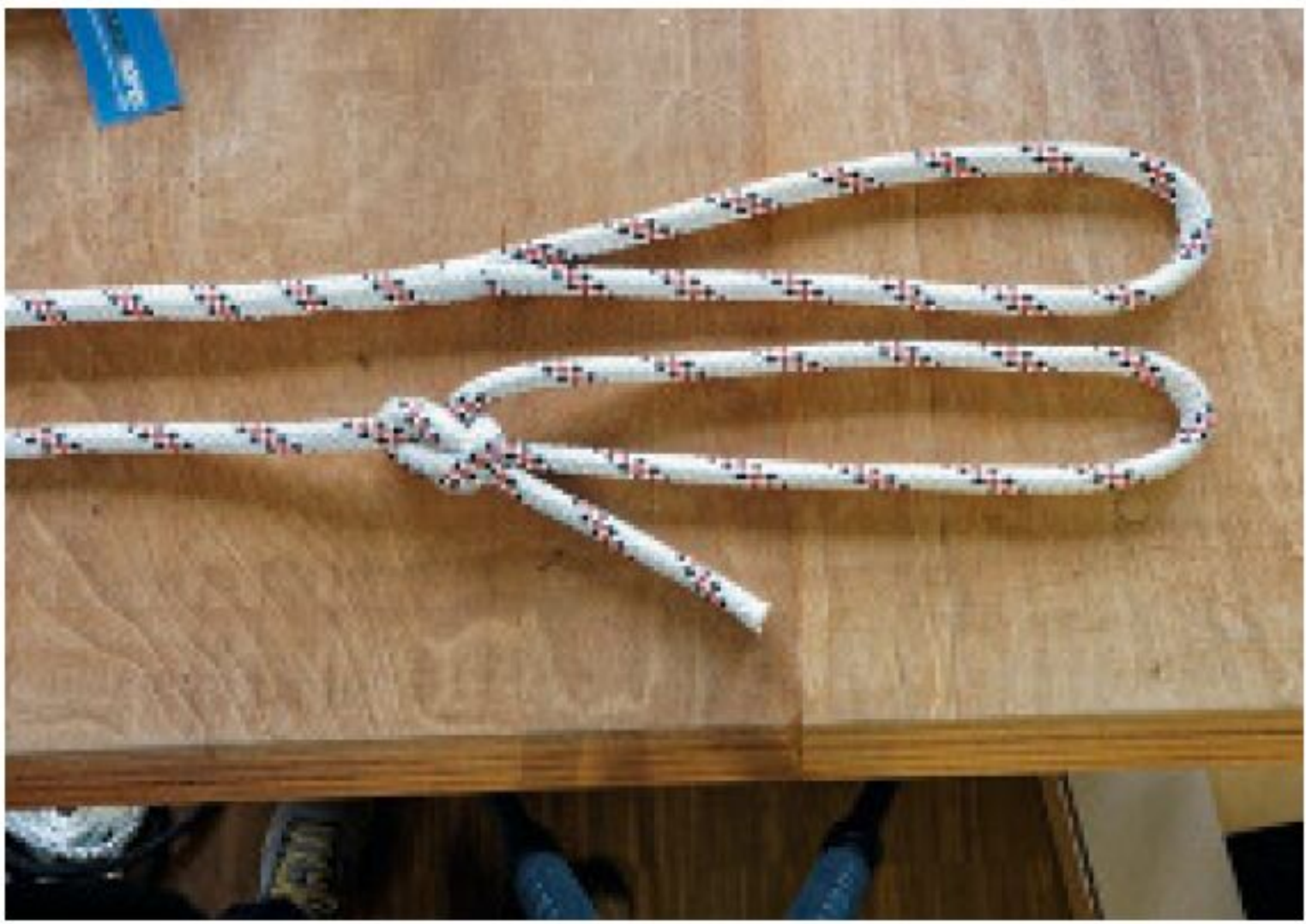
Spleiß oder Knoten? Der Palstek verringert die Bruchlast um 43 Prozent
