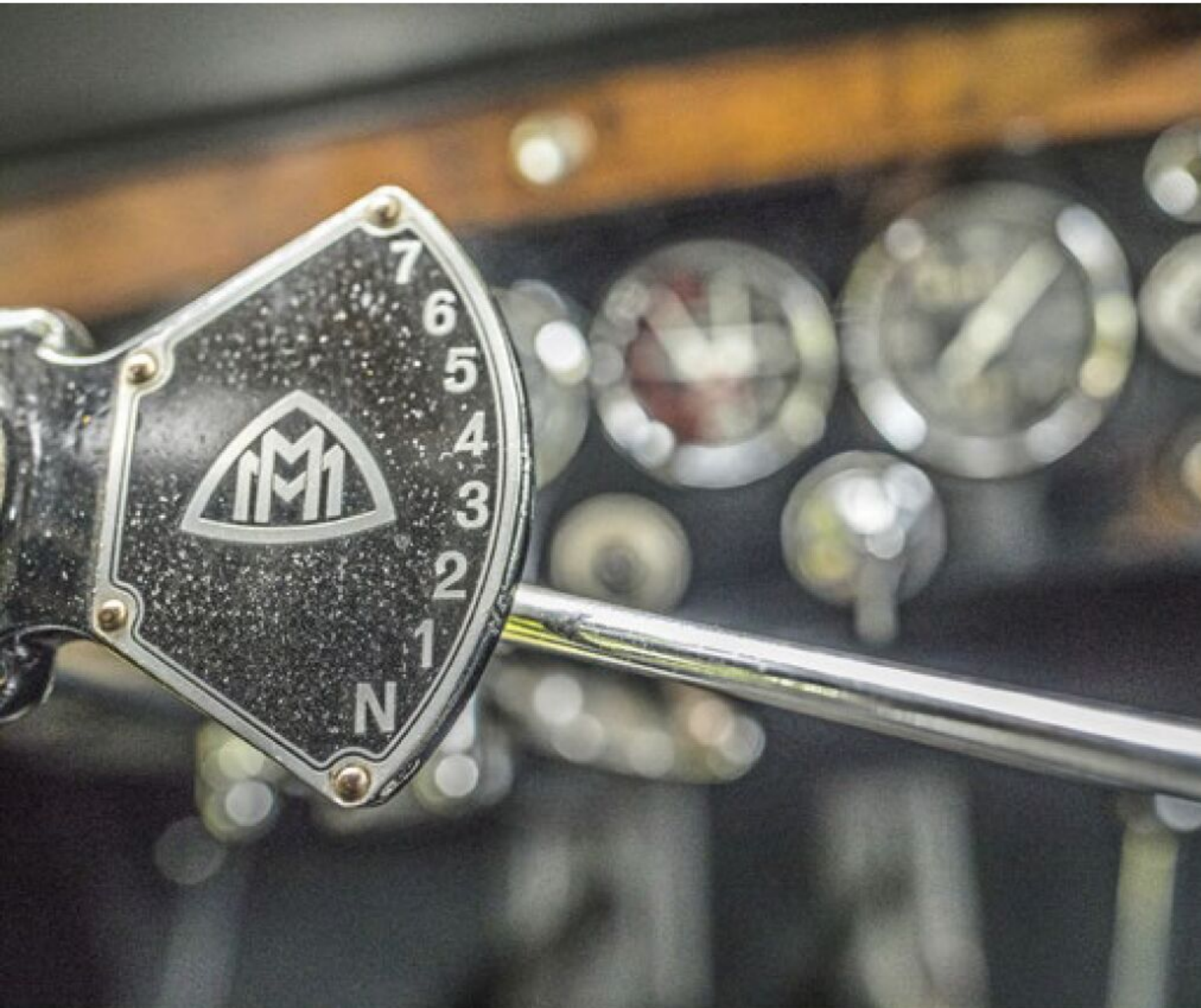
Beim Schaltreglergetriebe werden die Gänge vorgewählt. Äußerlich deutet unter anderem das vergoldete Symbol auf dem Kühlerschluss auf den V12 hin. Pullman-Landaulet von Spohn, integrierte hydraulische Wagenheber waren serienmäßig
