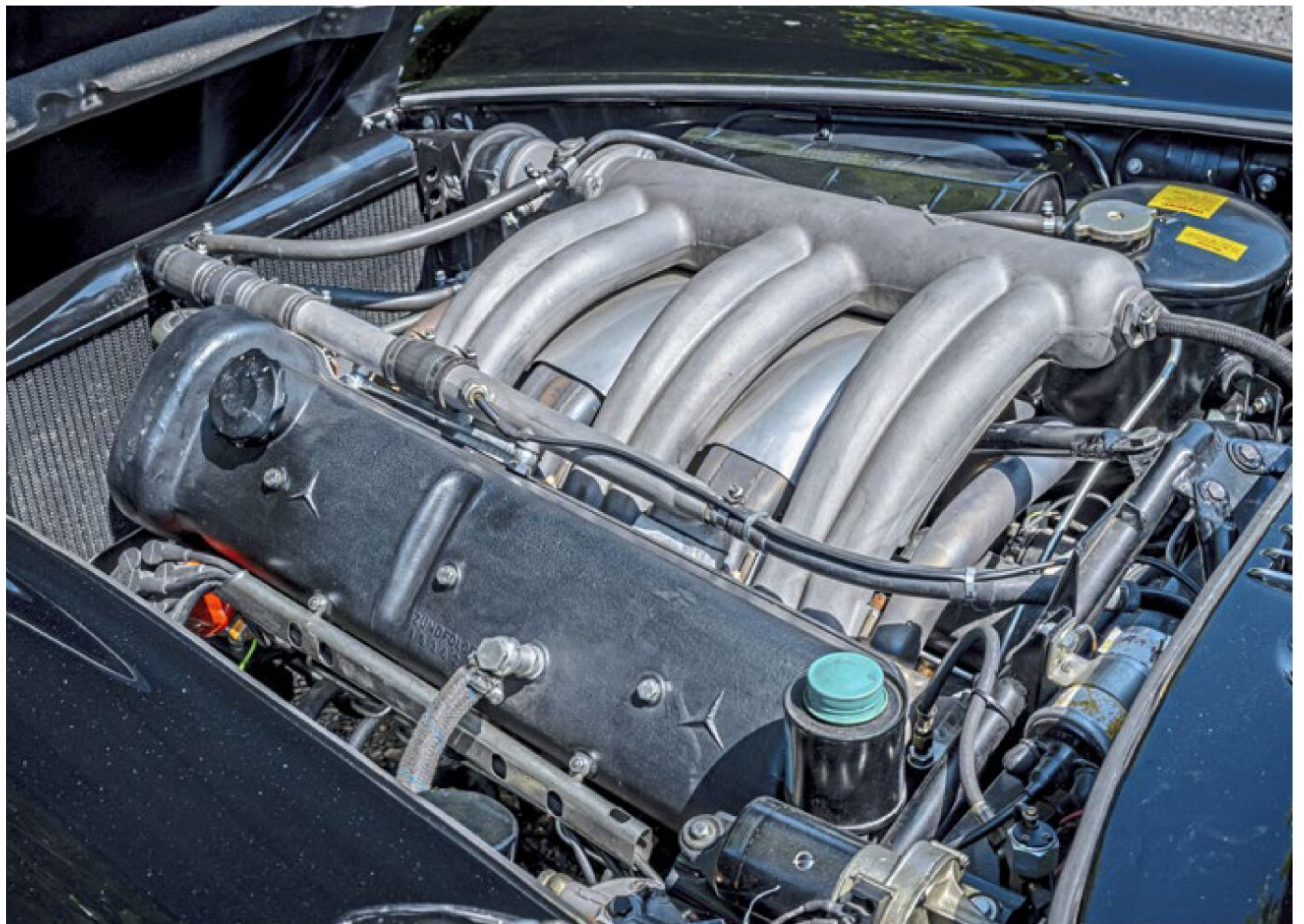
Den Sechszylinder trägt der SL um 45 Grad zur Seite geneigt. Die Zündfolge: 1-5-3-6-2-4. Der Klang: klasse, immer noch klasse
