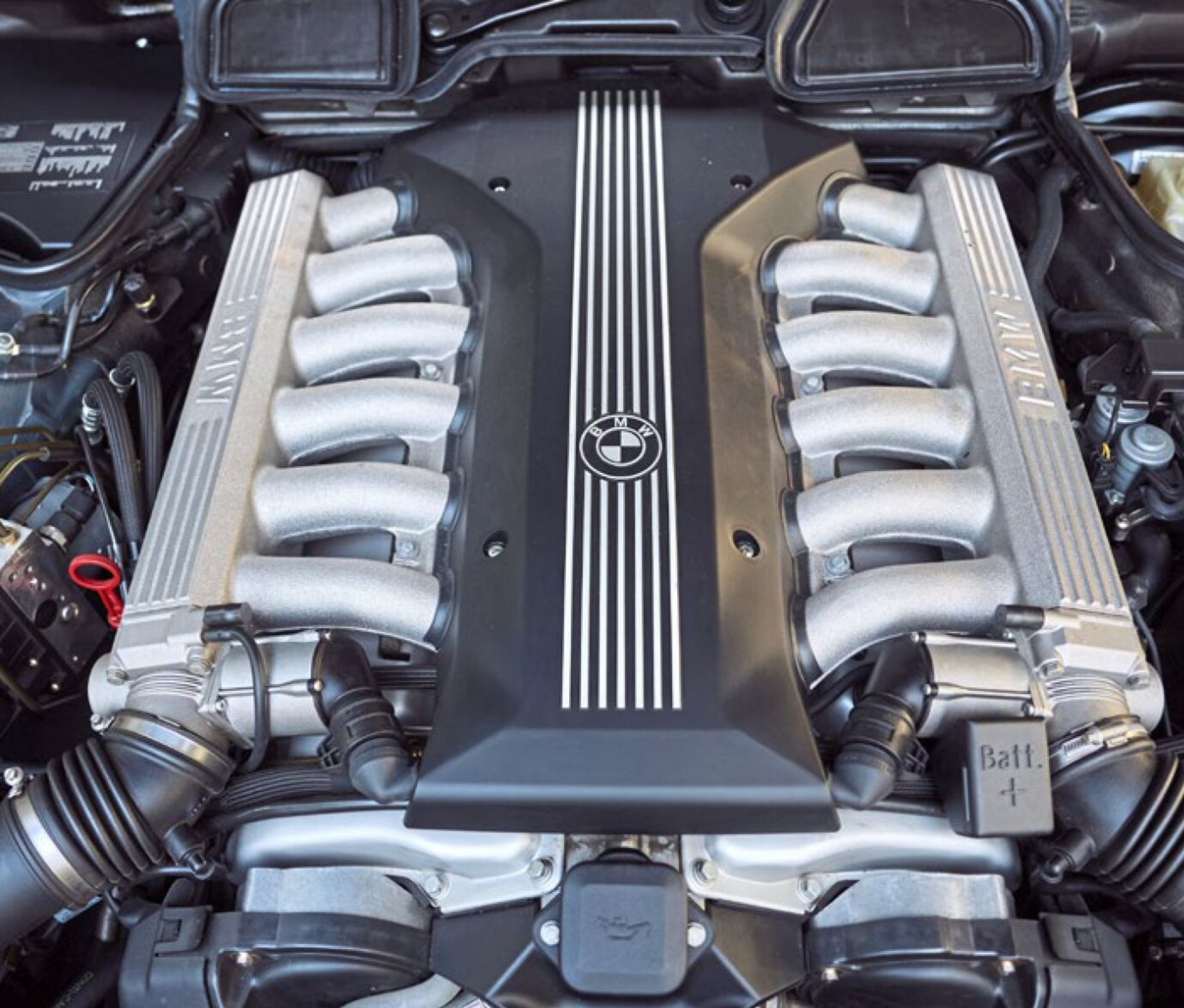
Der 5,4-Liter-V12 füllt den Motorraum komplett aus, die Antriebstechnik präsentiert sich zudem sauber arrangiert. Und: Ein V12-Emblem findet man nicht einmal am Heck
