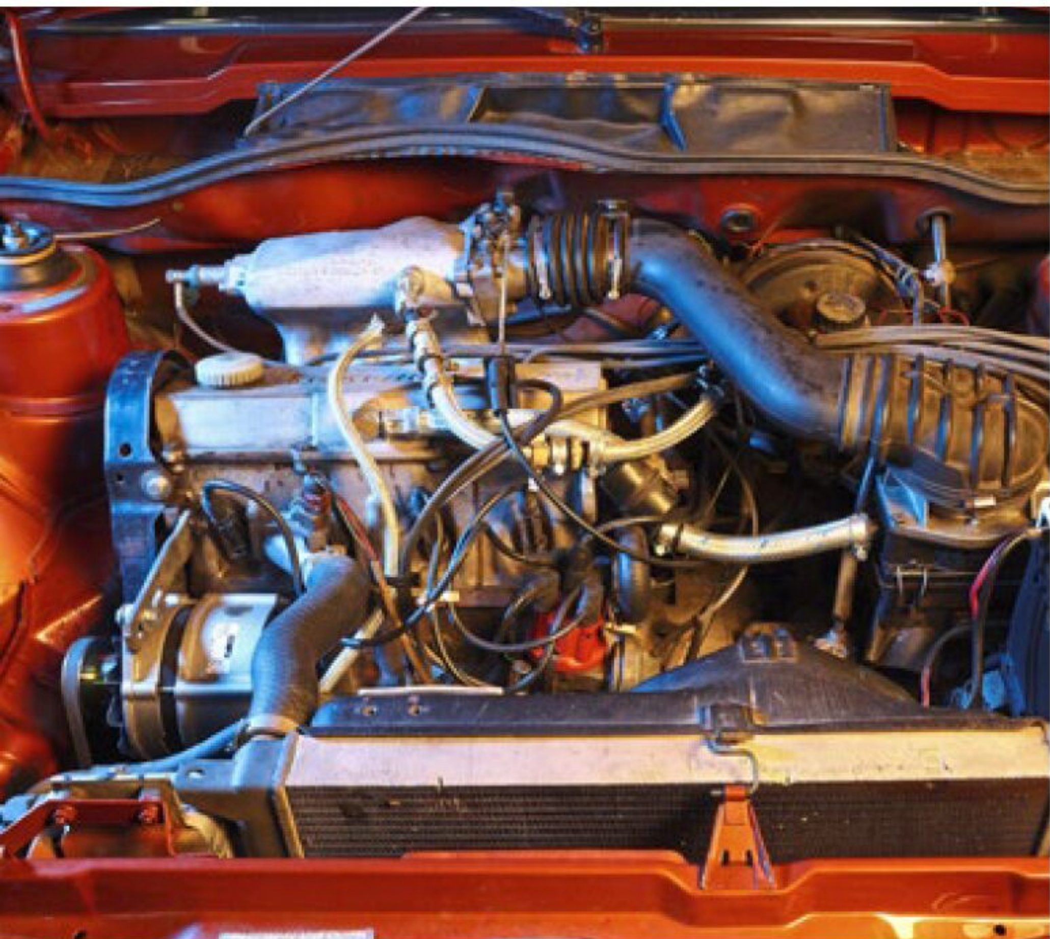
QUER EINGEBAUTE VIERZYLINDER Die 1,5- und 1,6-Liter-Motoren sind um 20 Grad nach hinten, die 1,1- und 1,3-Liter-Aggregate um 15 Grad nach vorn geneigt eingebaut
