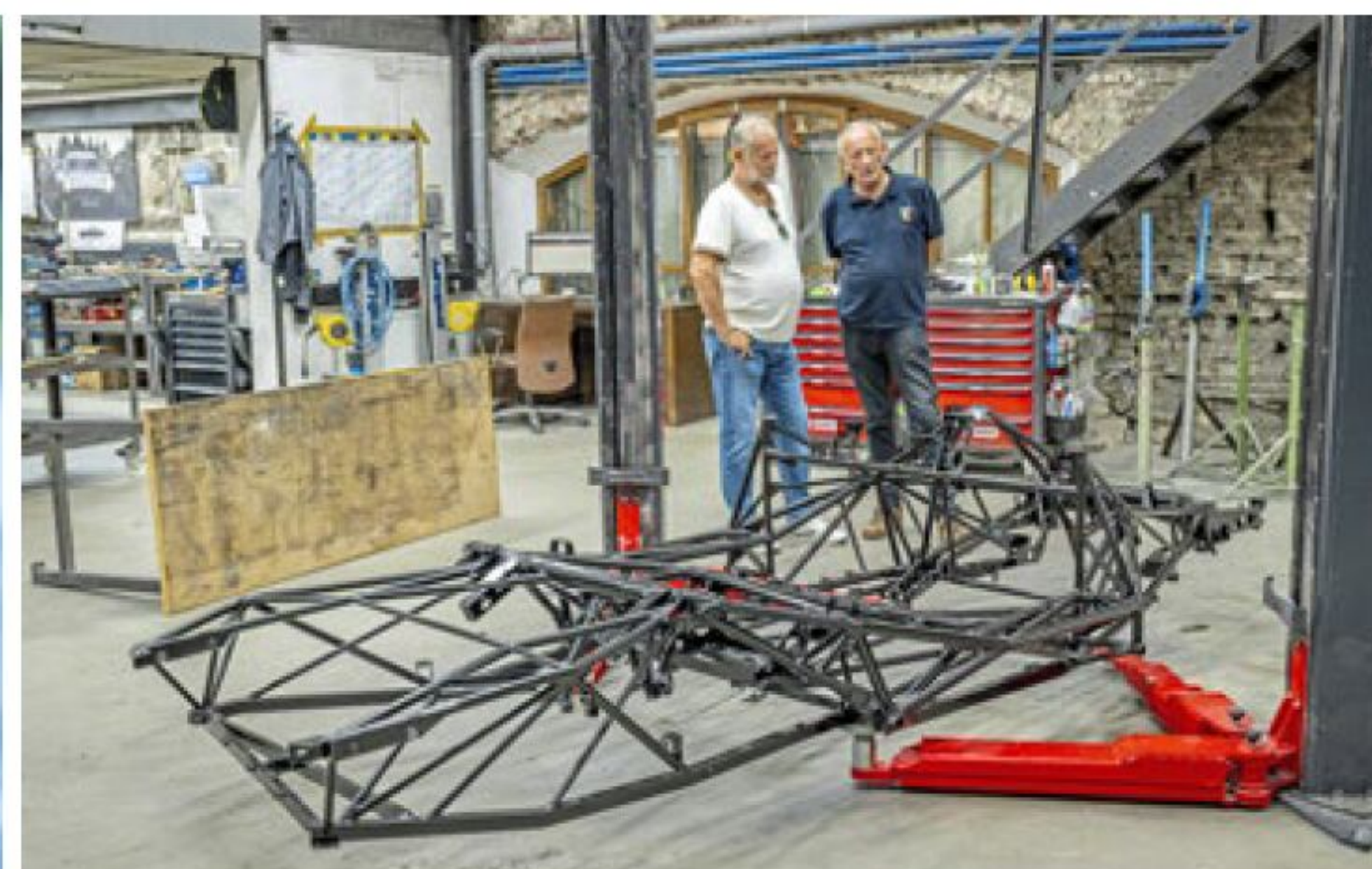
Die Rahmen werden auf den Millimeter gerichtet
