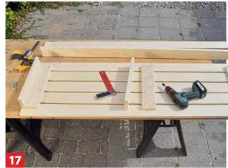
17 ... mit Schrauben 4,0 x 40 mm unter die fünf Sitzbretter P.
