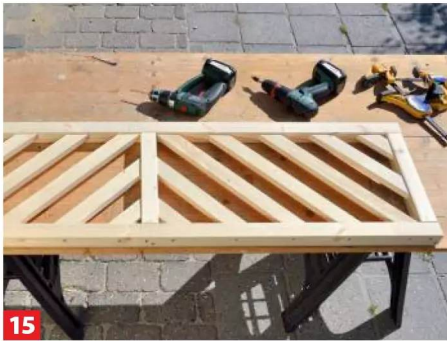
15 Hier nun die fertige Lehne der Bank aus diagonalen Streben im 45-Grad-Winkel.
