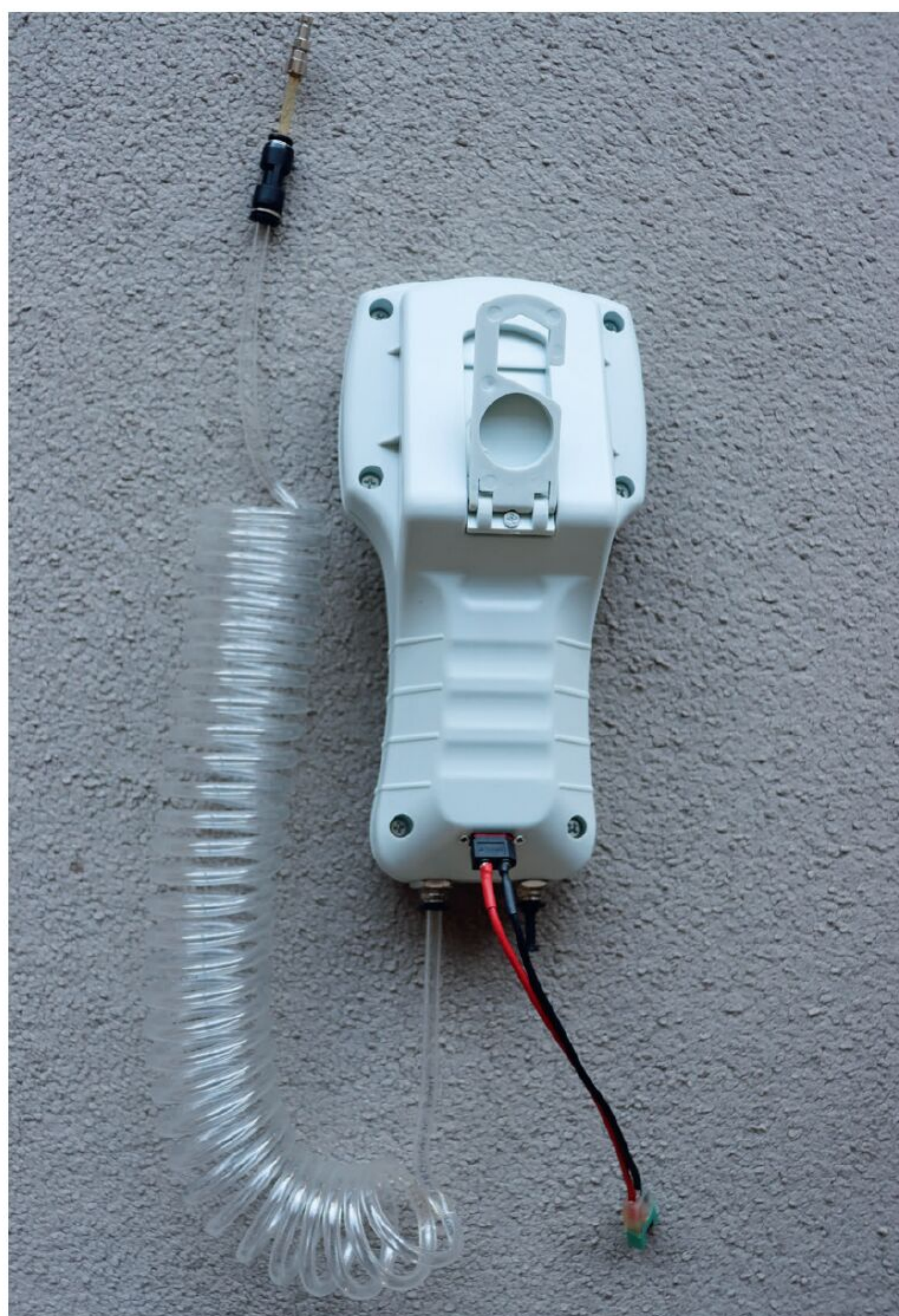
Die Rückseite mit dem ausklappbaren Haken und dem Adapterkabel für den Akkuanschluss. Der Tankschlauch ist bereits eingesteckt.
