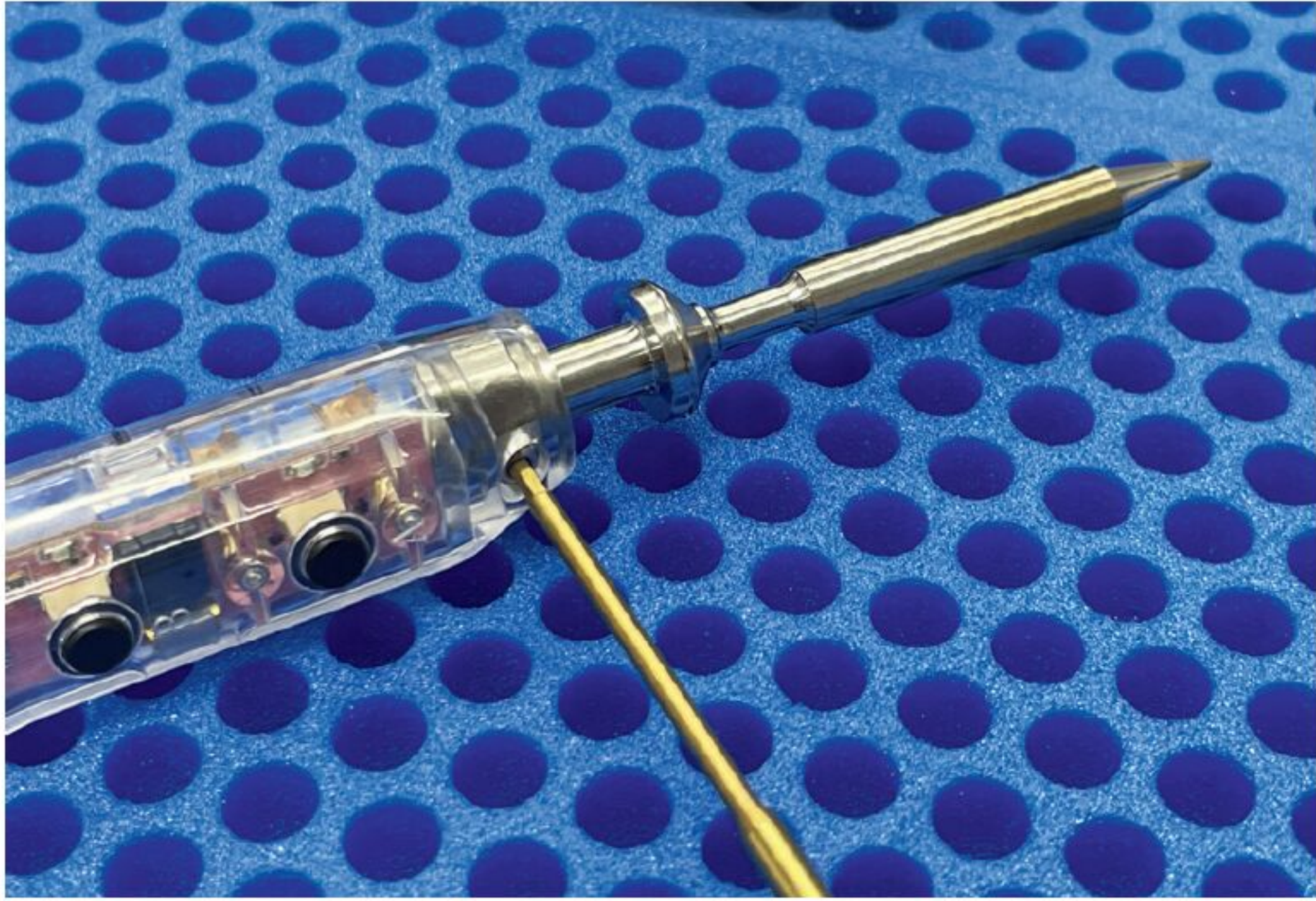
Die Lötspitze ist austauschbar. Laut Hersteller passen diverse Spitzen aus dem Zubehör.
