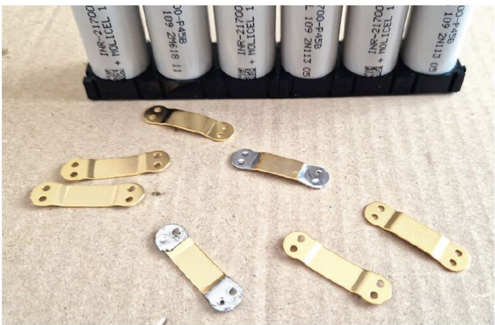
Kunststoff-Aufnahmen sorgen für einen stabilen und ordentlichen Verbund der Zellen. Hier wurden sechs 2p-Konfigurationen in Reihe geschaltet.
