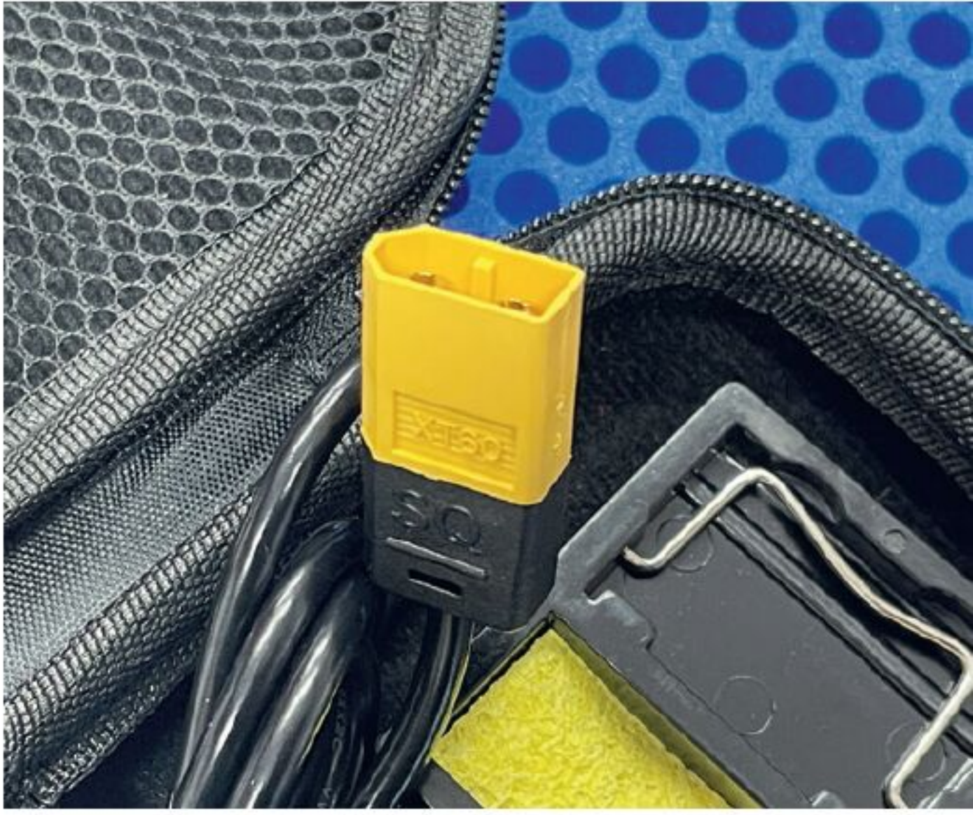
Das Anschlusskabel kommt praktischerweise mit XT60-Stecksystem und kann so direkt an den meisten Akkus betrieben werden.
