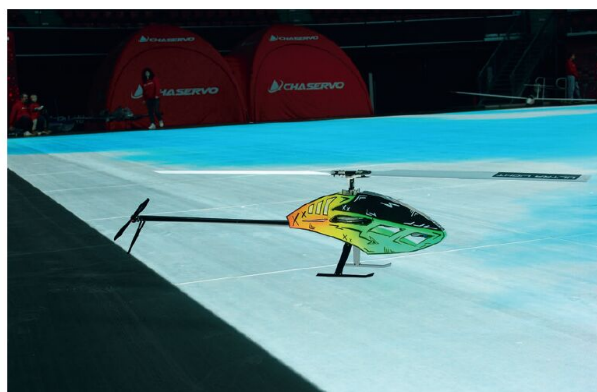
Der 700er Ultralight-Heli von Daniel Hör bringt gerade mal 600 g auf die Waage, lässt sich aber durch alle 3D-Figuren fliegen.
