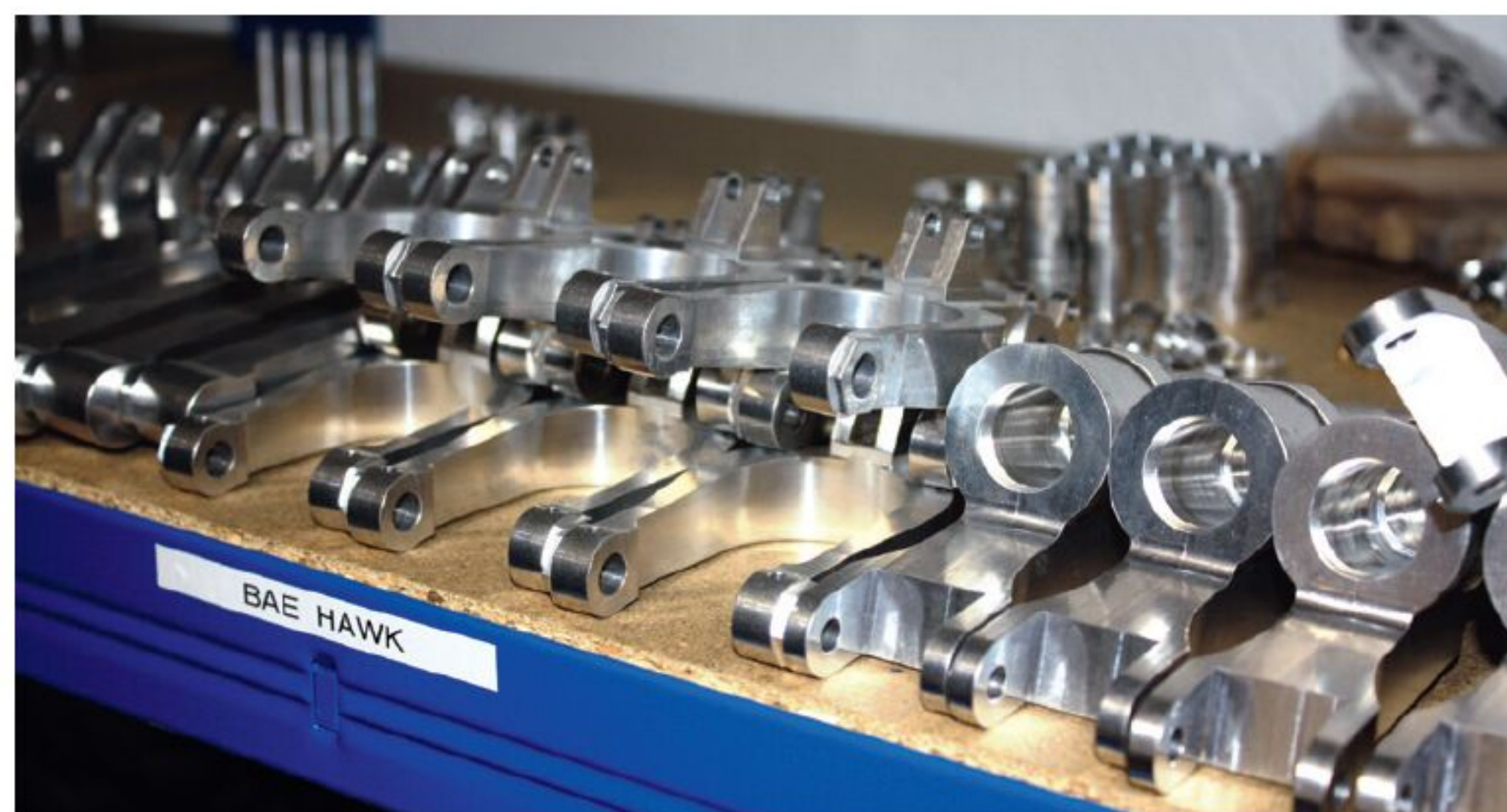
Aus bestem Luftfahrtaluminium aus dem Vollen gefräst. Hier ist nichts geschweißt, gelötet oder geklebt.
