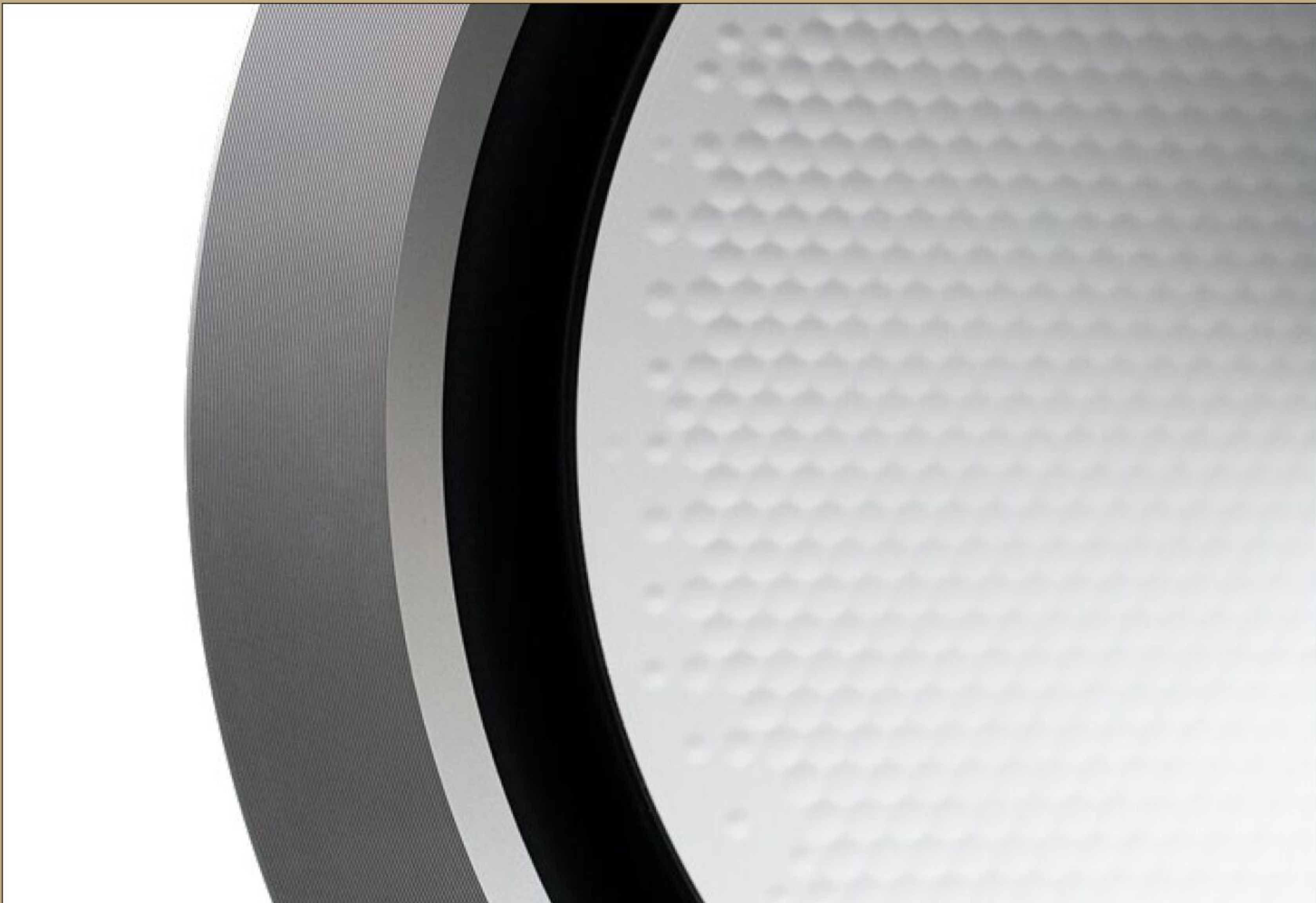
Die neue HDT-C-CAM-Membran sorgt dafür, Symmetrien und somit stehende Wellen im Bereich der Aufbruchsfrequenz auf der Membran zu vermeiden
