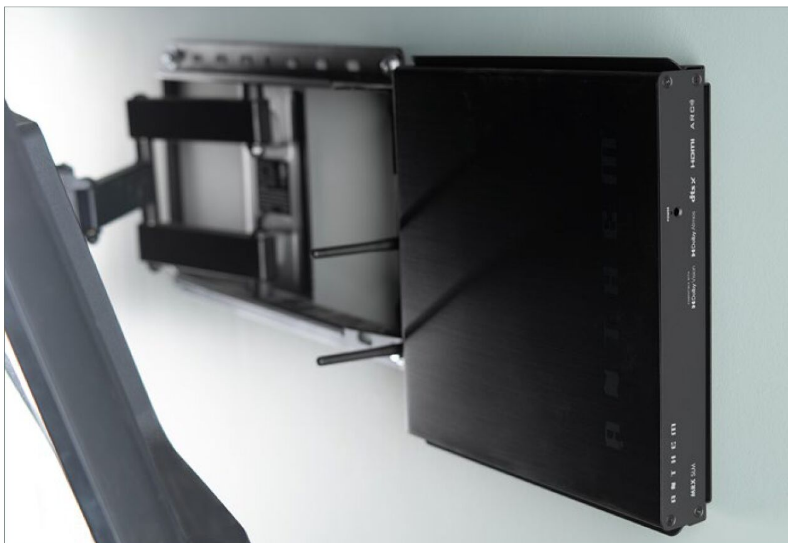
Der Anthem MRX SLM ist ein sehr platzsparender AV-Receiver. Dank seines flachen Formfaktors und der Wandhalterung kann man ihn gut hinter dem TV verstecken
