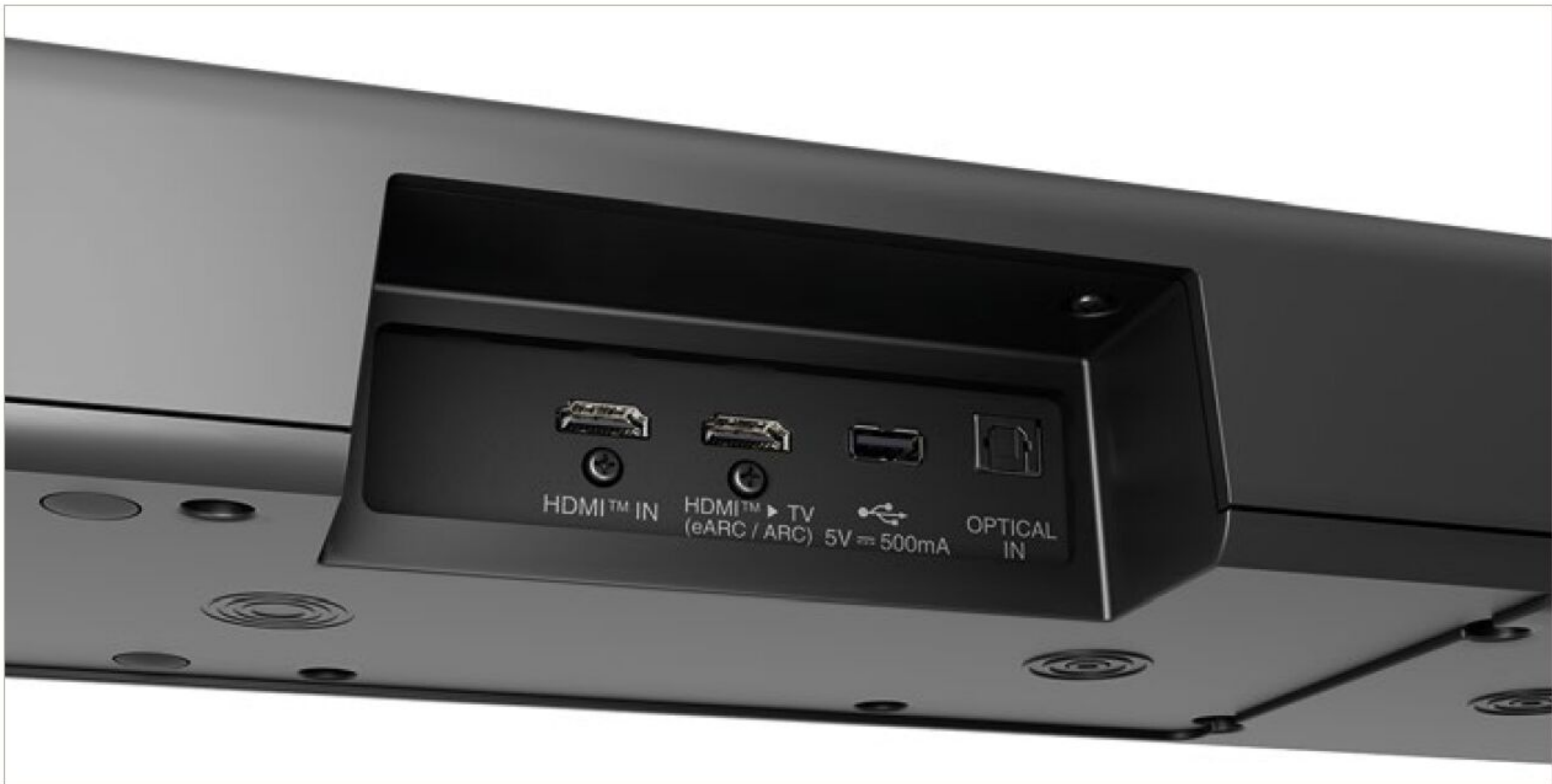
Die Anschlüsse der Soundbar decken Grundlegendes ab. Ein weiterer HDMI-Eingang wäre dennoch wünschenswert gewesen
