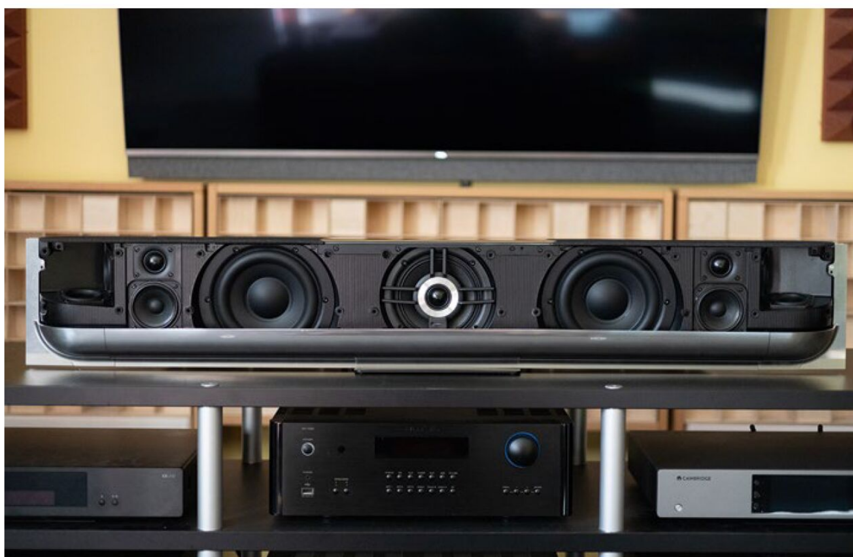
Insgesamt besitzt die Beosound Theatre 12 Treiber, mit denen sie 7.1.4 Sound realisiert, der aber nicht vollends überzeugt
