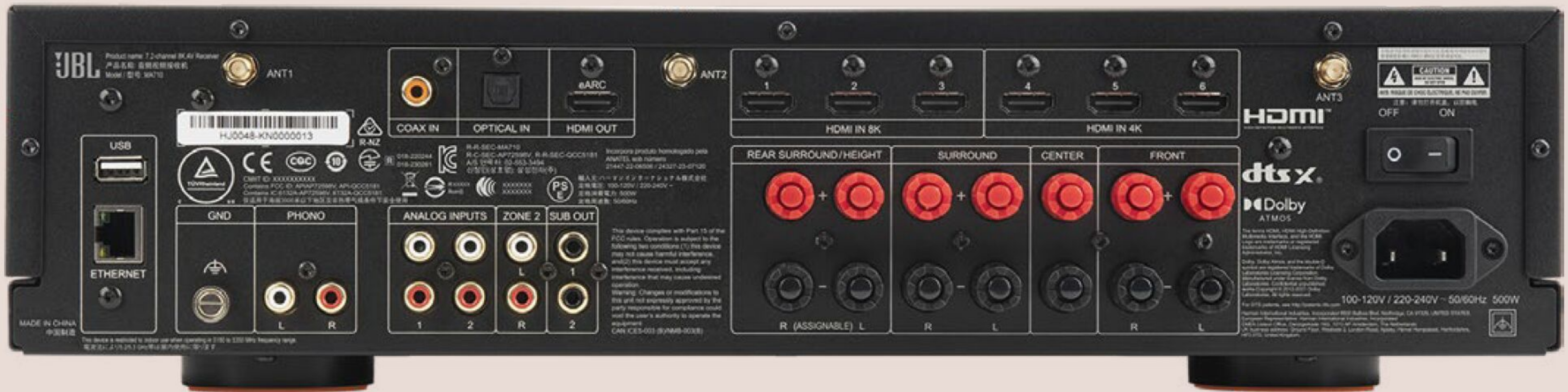
Das Anschlussterminal des JBL MA710 fällt sehr vielseitig aus. Die Lautsprecherausgänge 7 und 8 lassen sich für unterschiedliche Anwendungen nutzen
