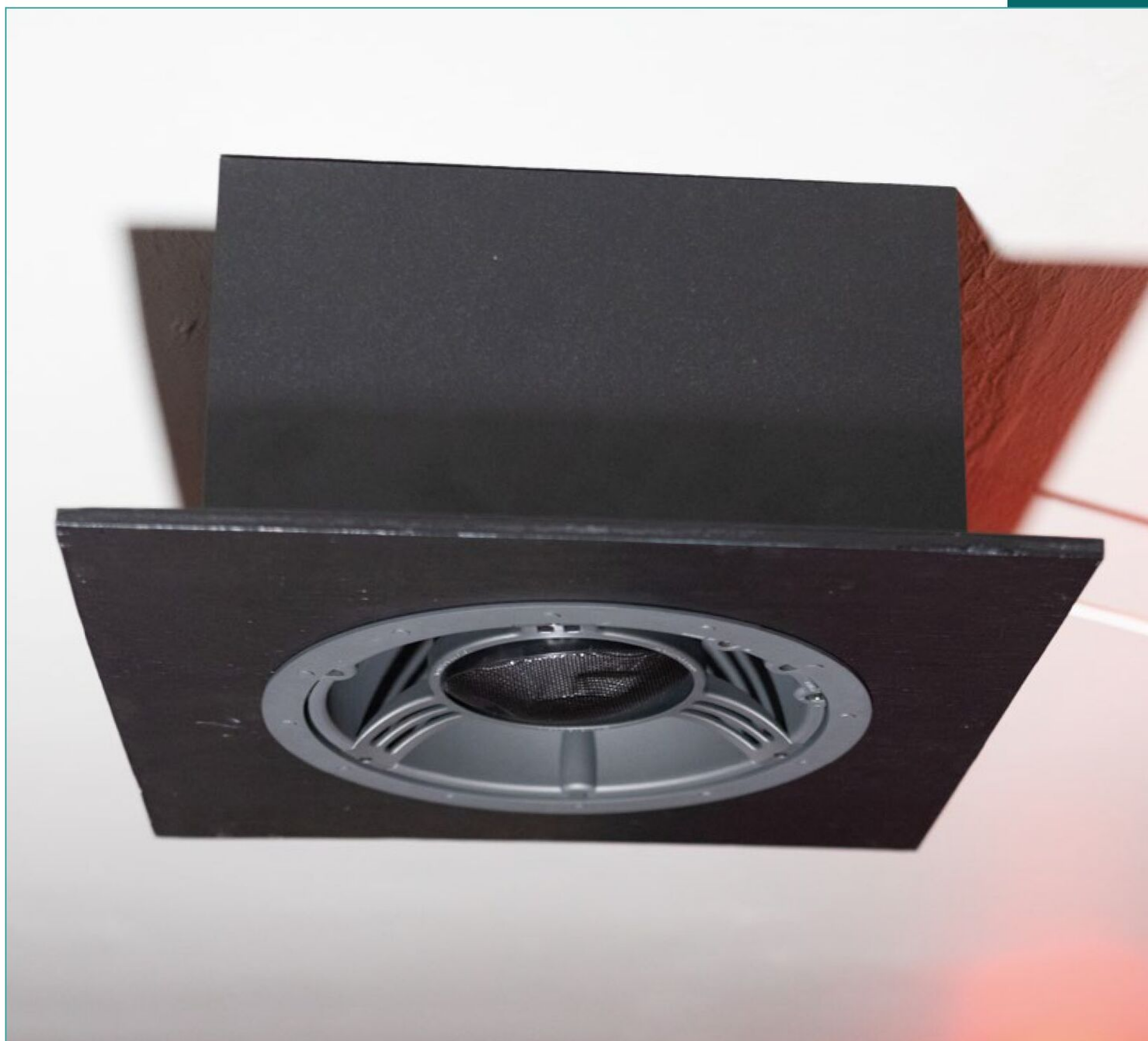
Deckenlautsprecher wie hier zu sehen, sind bei Dolby Atmos und anderen vektorbasierten Formaten die erste Wahl. Alternativ können Upfiring-Lautsprecher genutzt werden, diese sind aber weniger präzise
