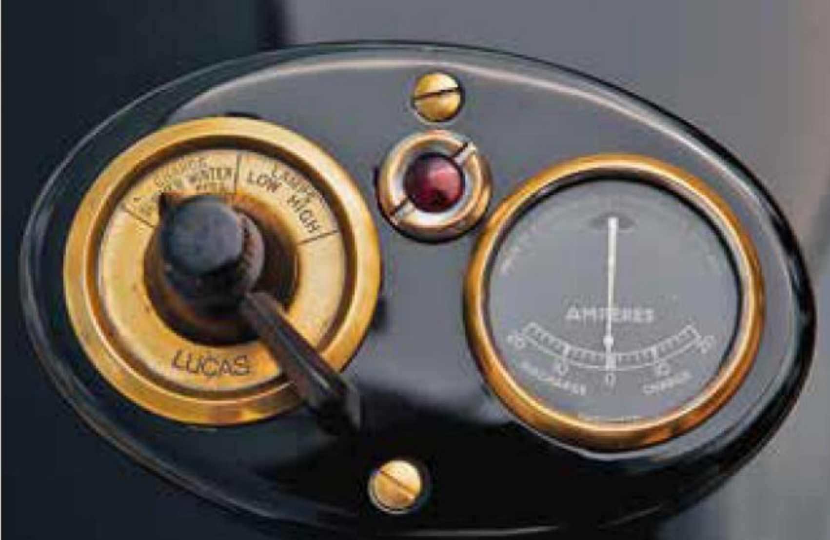
Kunstvoll: Die Instrumente zur Ladekontrolle sind mittig auf dem Tank untergebracht.
