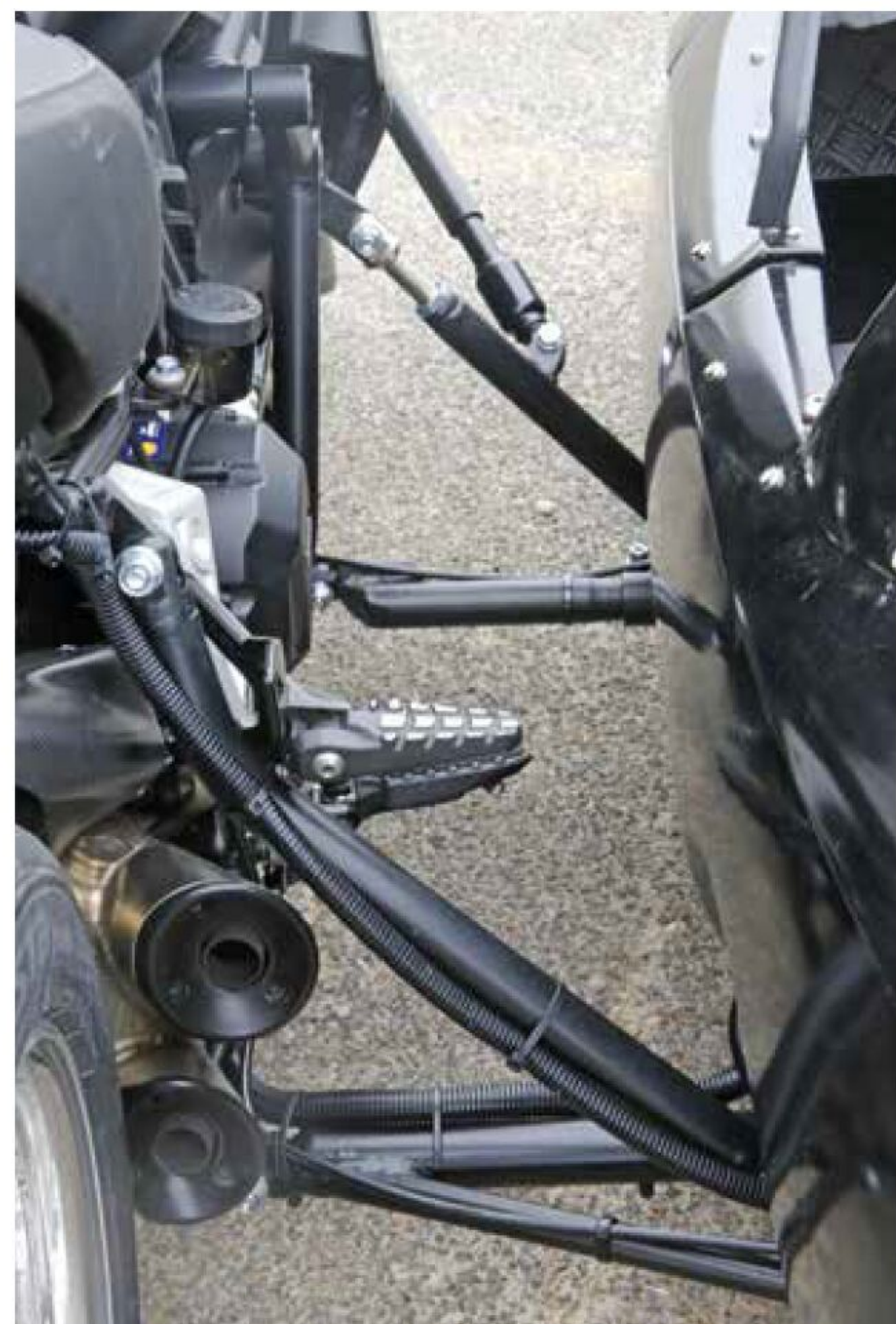
Pragmatisch: Beidseitig verschraubter Verstärkungsrahmen, vier Anschluss-Streben.
