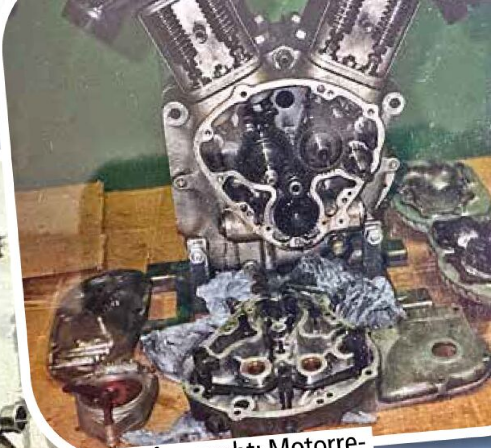
Aufgemacht: Motorrevision in vollem Gang.
