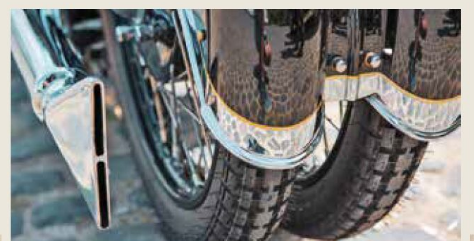
Zwei wie Eins: Weil die Hinterräder eng beieinander stehen, werden sie wie eins behandelt.
