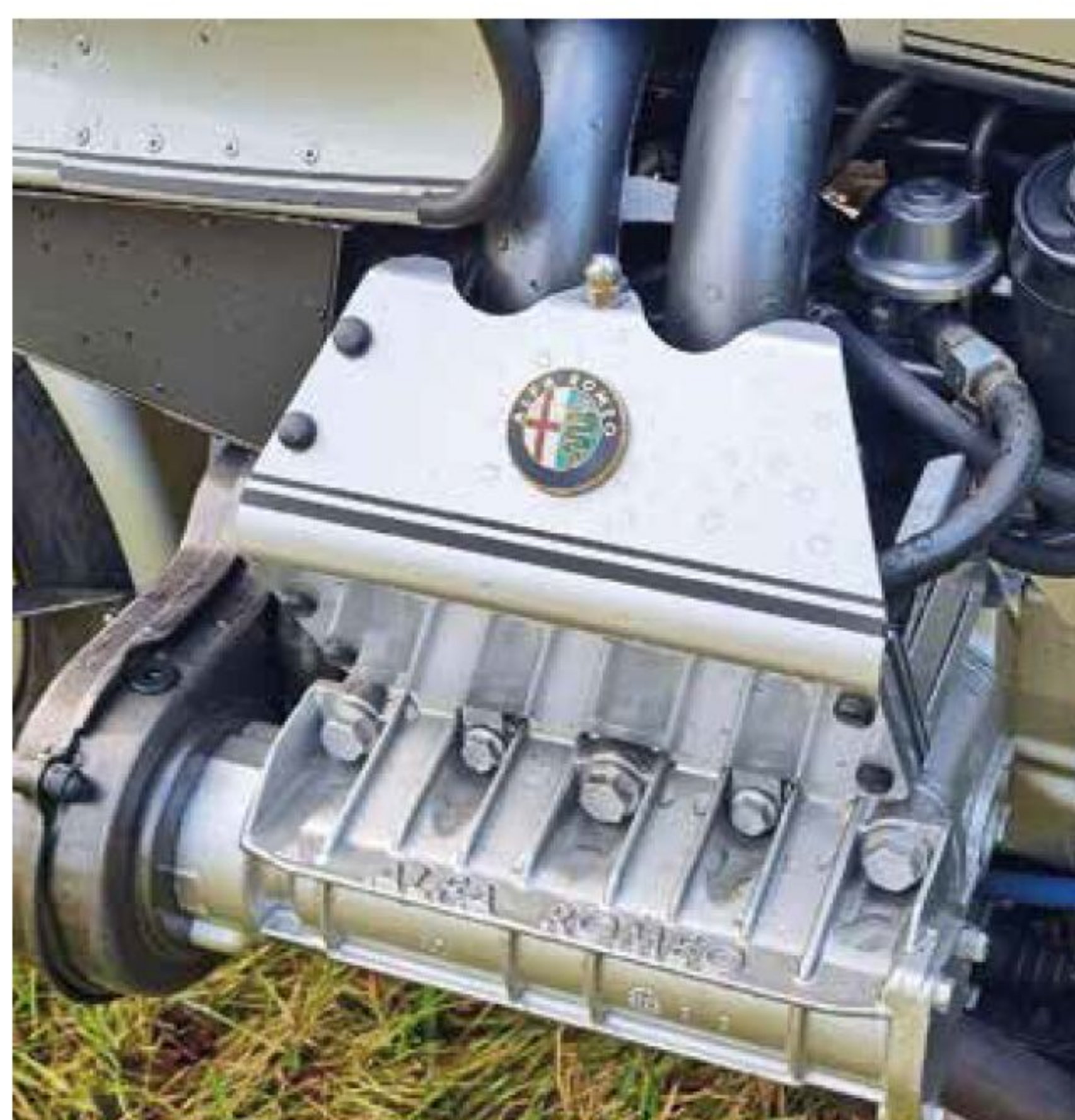
Großer Brocken: Der Alfa-Romeo-Motor treibt das schwere Gespann mit 115 PS vorwärts.
