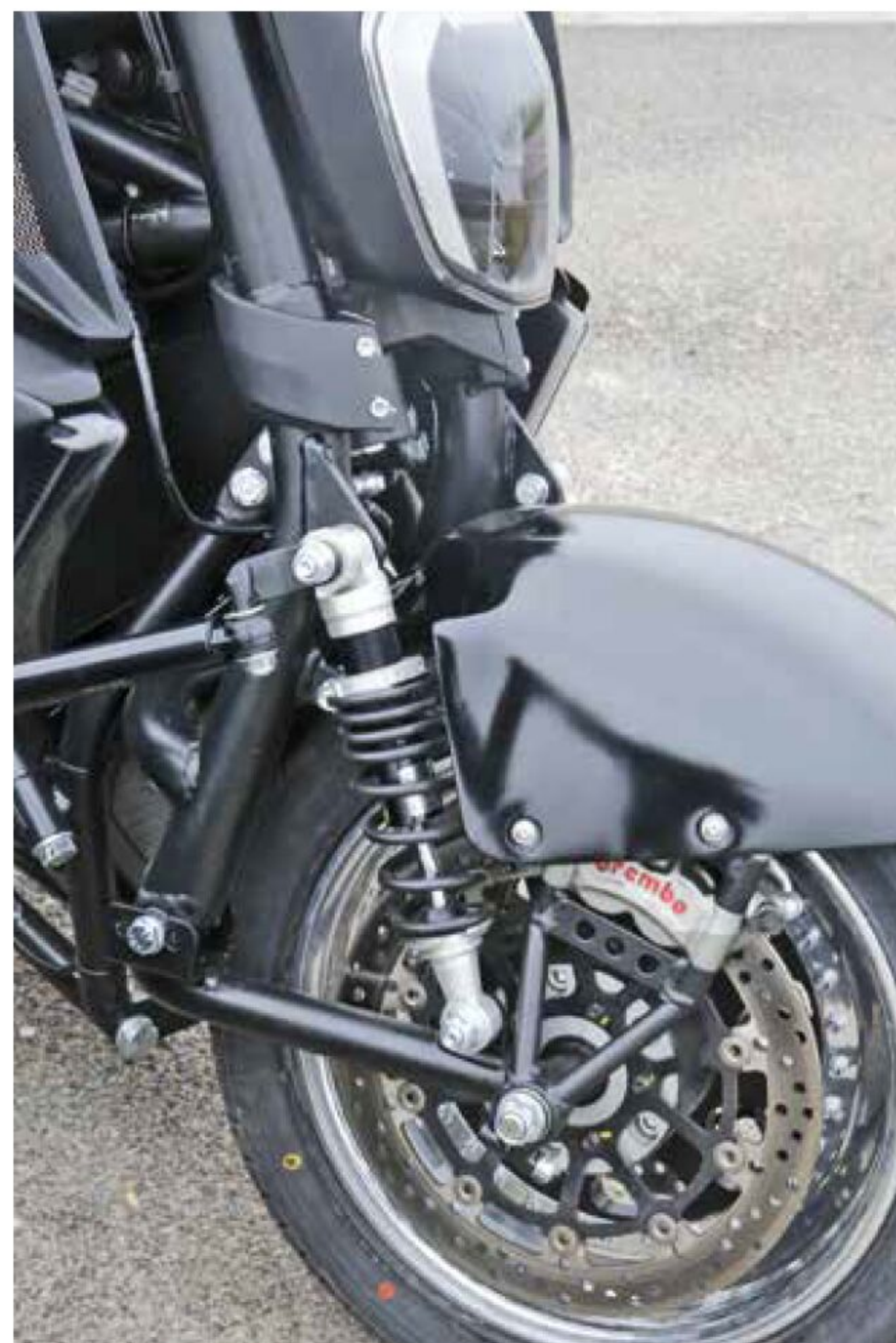
Alternative zur Achsschenkelenkung: Schwingengabel mit Federbeinen von YSS.
