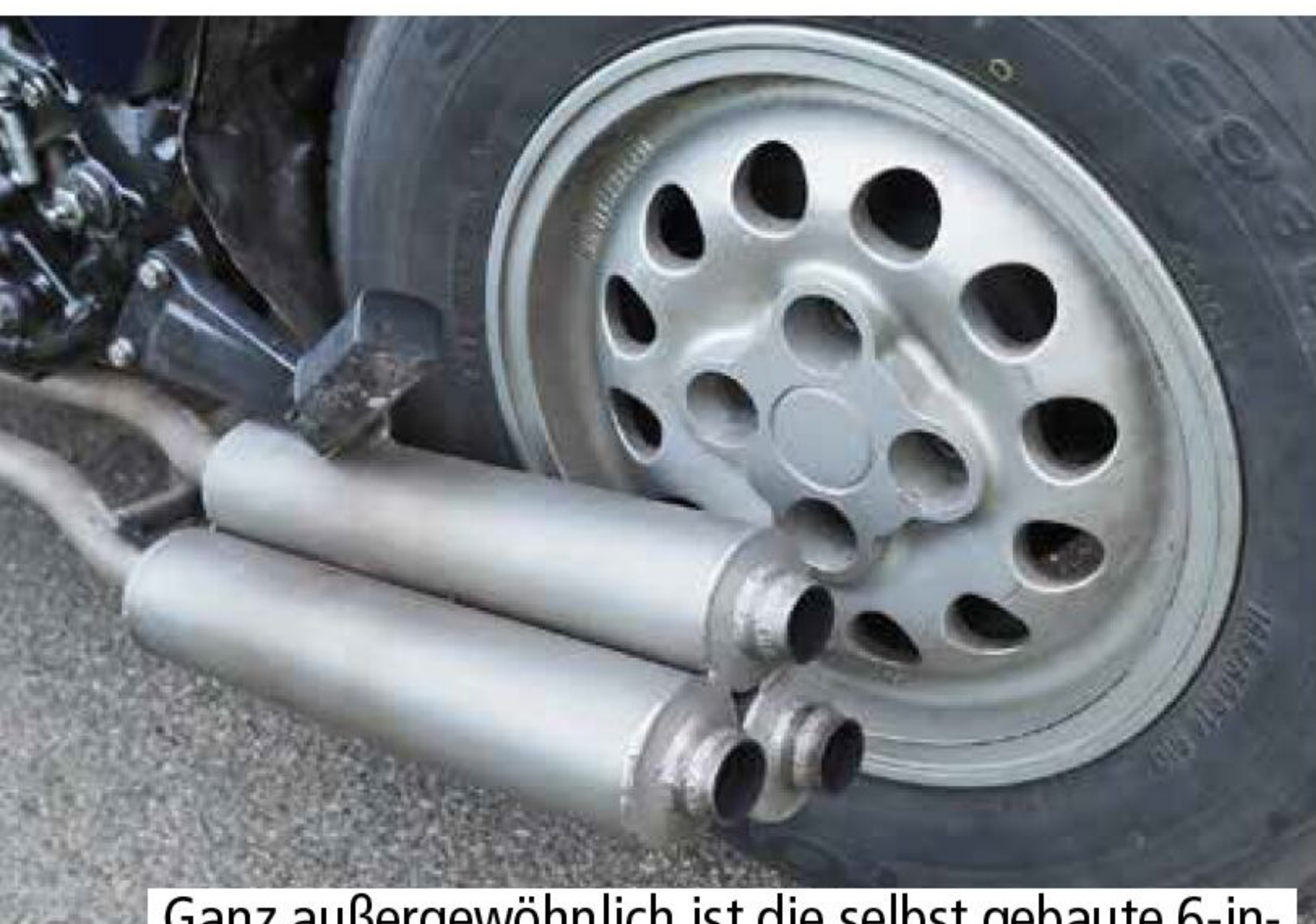
Ganz außergewöhnlich ist die selbst gebaute 6-in-6-Anlage, hier auf der linken Seite zu sehen.
