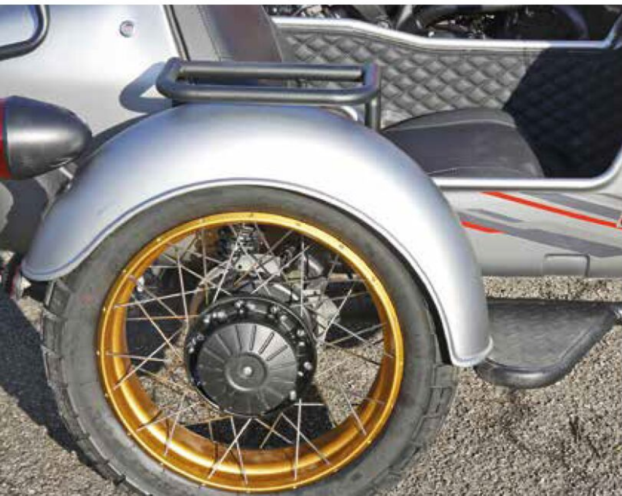
Austauschbar: Das Bootsrad im Format des Hinterrades wird per Pedal mit verzögert.
