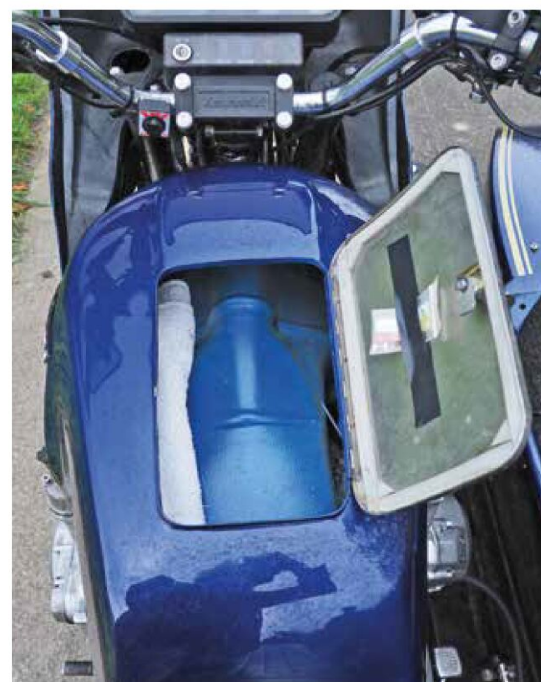
Der ehemalige Benzintank wurde zum Aufbewahrungsfach für Handschuhe und anderes umgebaut.
