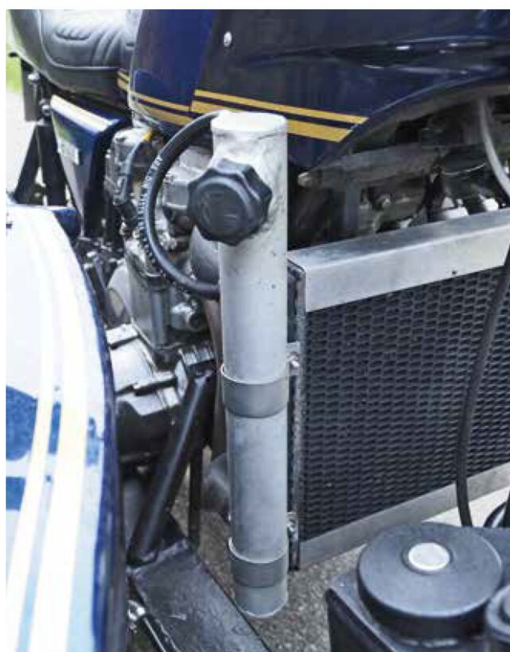
Über den Tankstutzen wird der seitliche Hilfsrahmen mit etwa 12 Litern Spirit befüllt.
