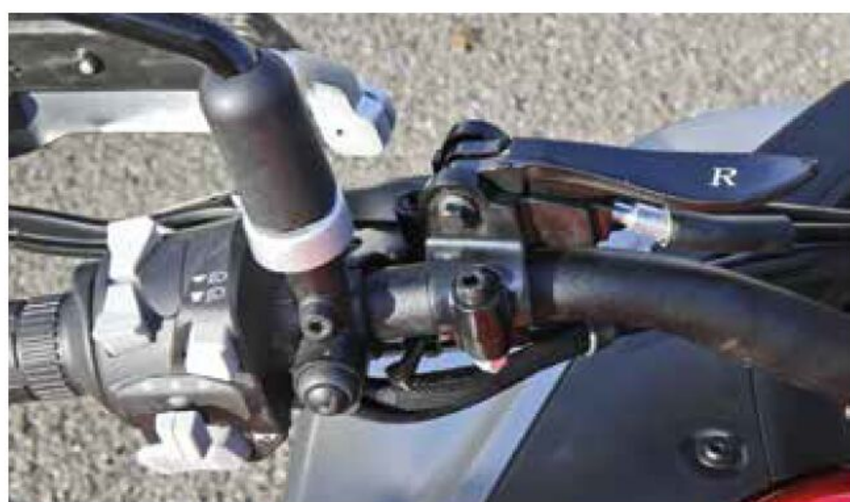
Reduziert: Die Schaltereinheit mit Reverse-Hebel unterscheidet sich vom SRT-Pendant.
