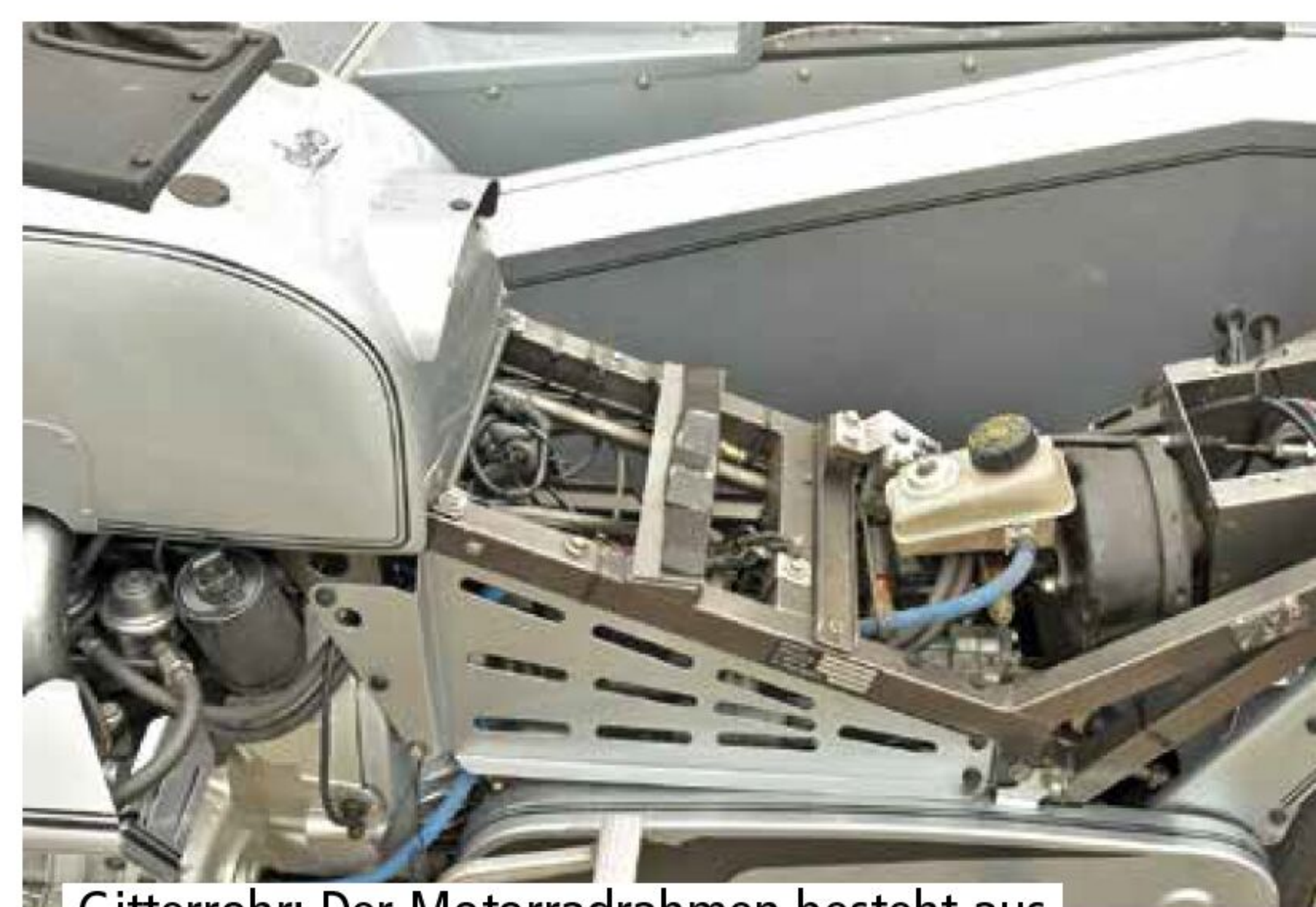
Gitterrohr: Der Motorradrahmen besteht aus einem stabilen Geflecht von Vierkantprofilen.
