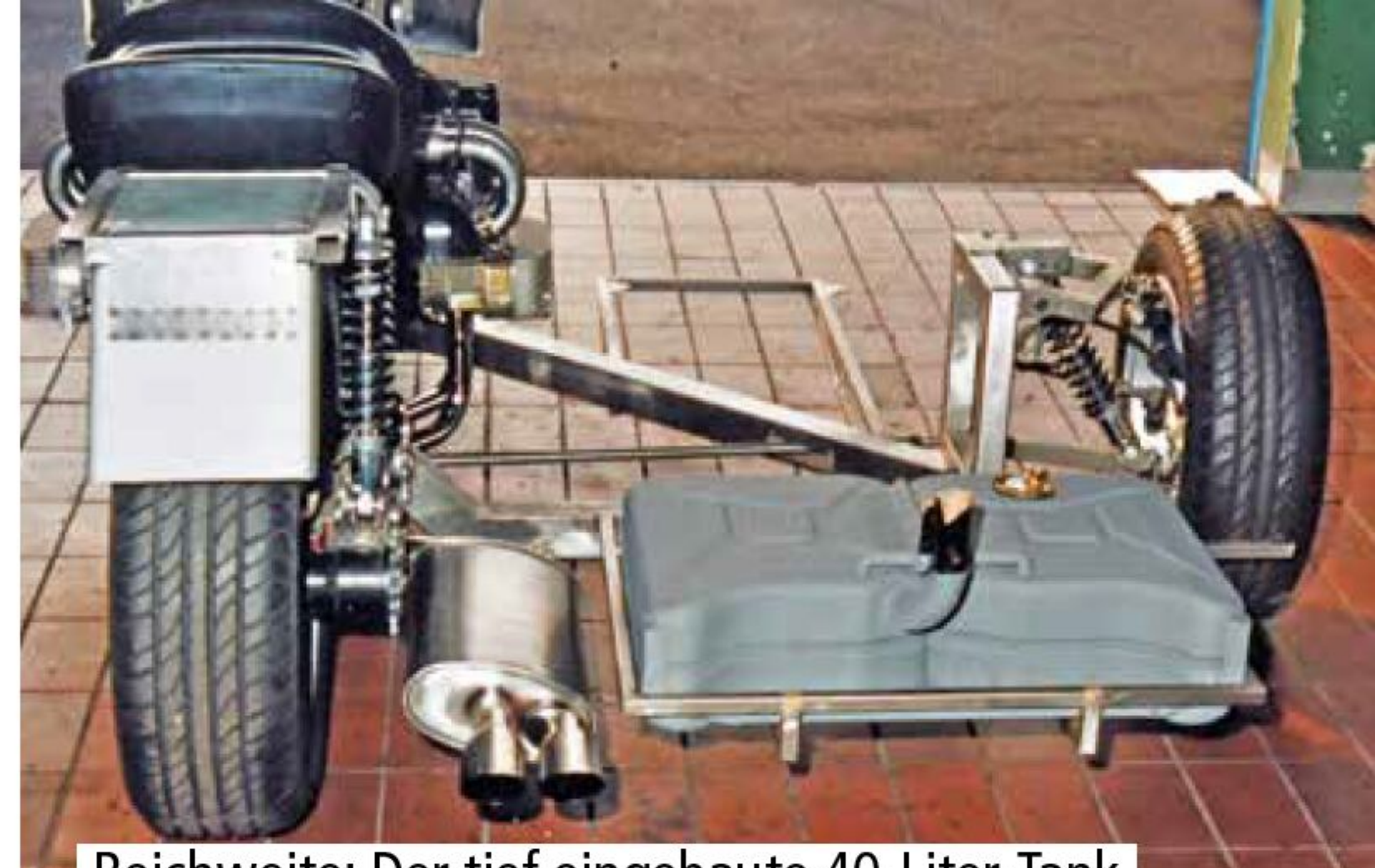
Reichweite: Der tief eingebaute 40-Liter-Tank dehnt die Tankintervalle auf 400 Kilometer.
