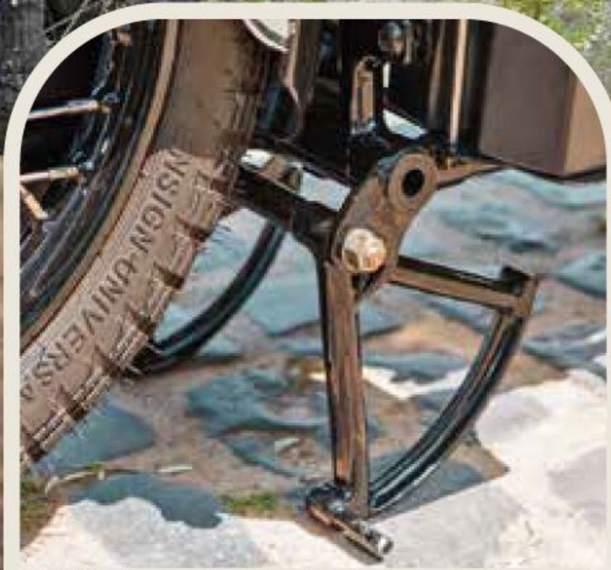
Weltneuheit: Der patentierte „Easy Roll On Centre Stand“ war an der BS4 erstmals verbaut.
