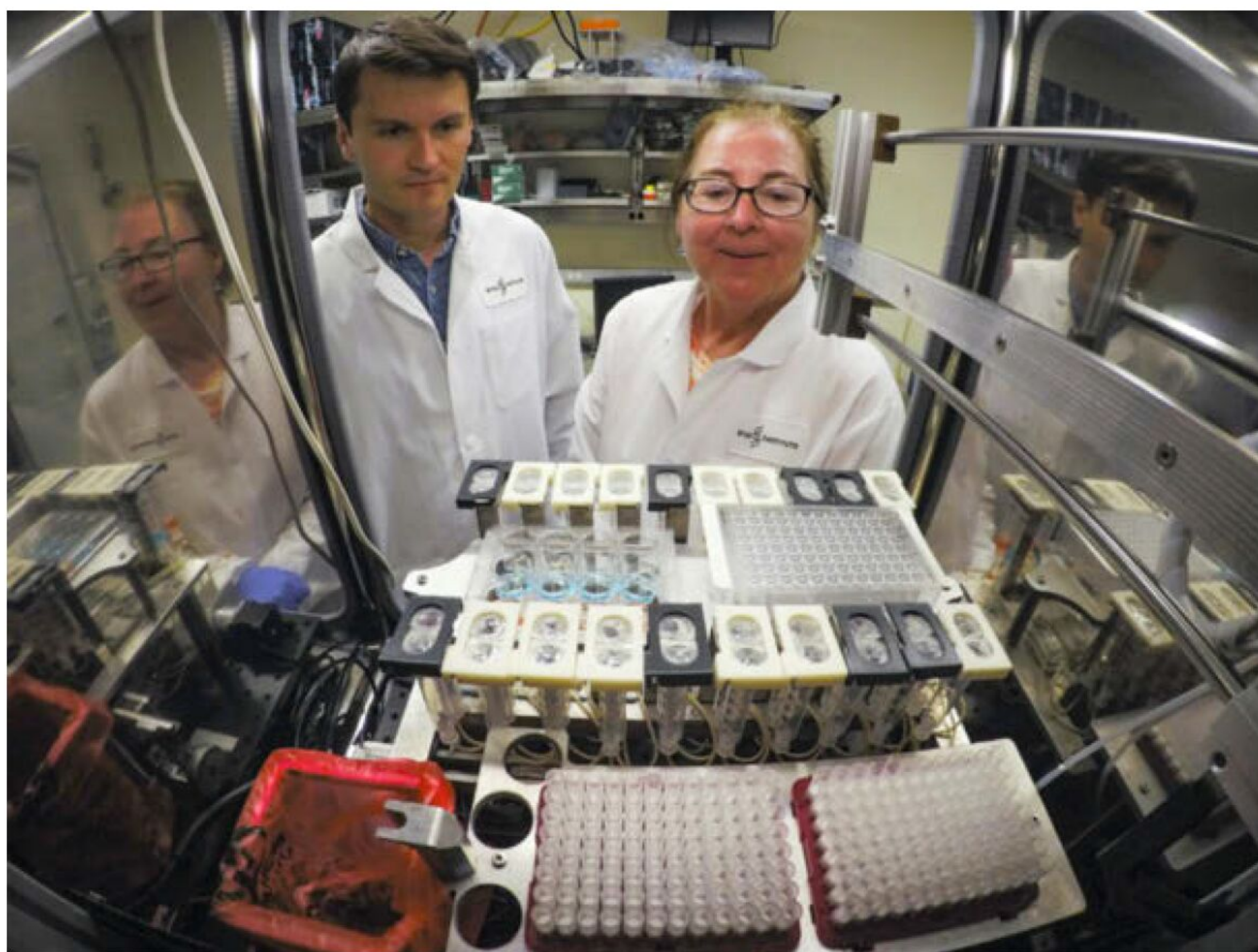
Zwei Forschende arbeiten am Interrogator, einem Gerät, das beim automatisierten Züchten und Aufbewahren von Testchips mit organähnlichen Geweben hilft. Der Interrogator hat Platz für bis zu zehn verschiedene Chips.
