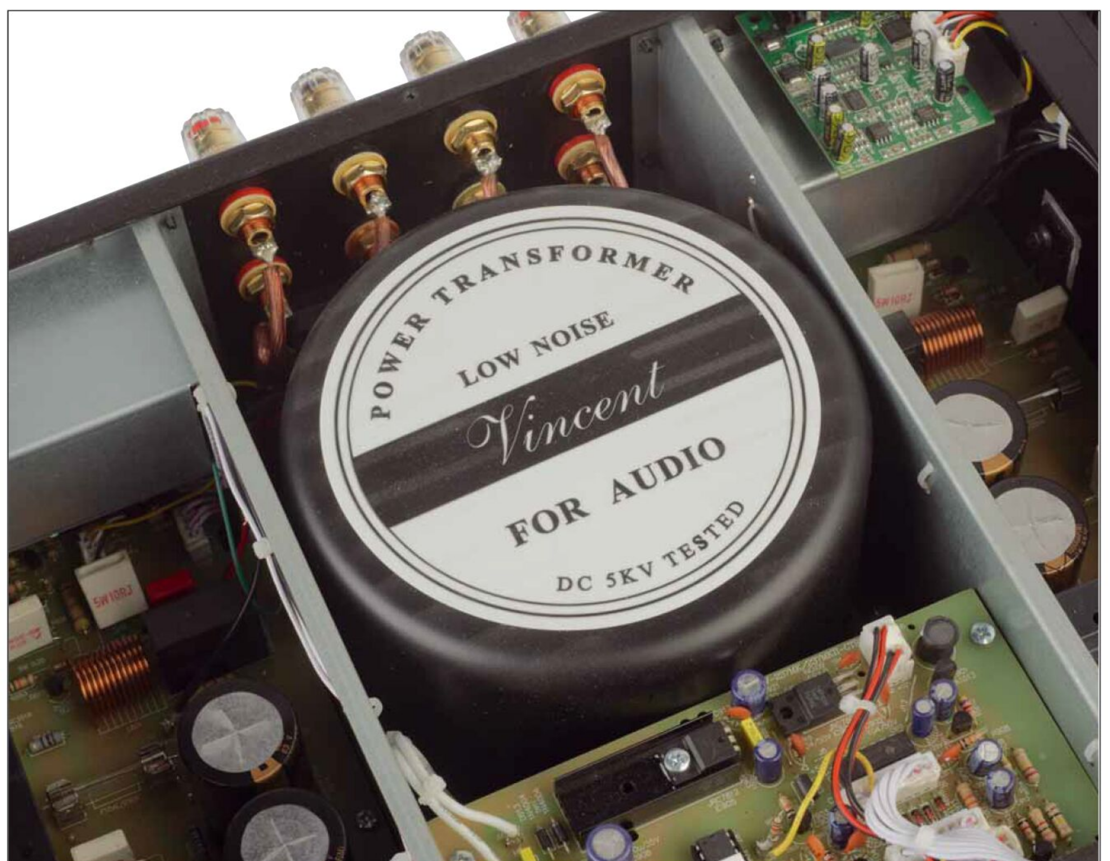
Man sagt ja gerne, das Netz macht die Musik. Hier sorgt jedenfalls ein ernsthaft massiver Ringkerntrafo für mehr als genügend Leistungsreserven
