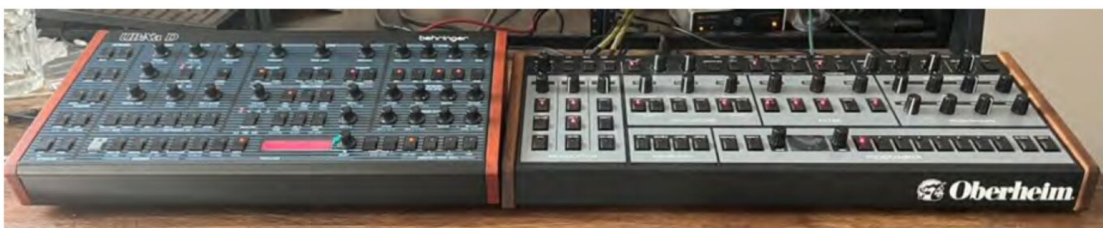
Der UB-Xa D kann mit Hilfe der mitgelieferten Winkel auch in ein 19Zoll Rack eingebaut werden, der OB-X8 Desktop ist hierfür zu breit.
