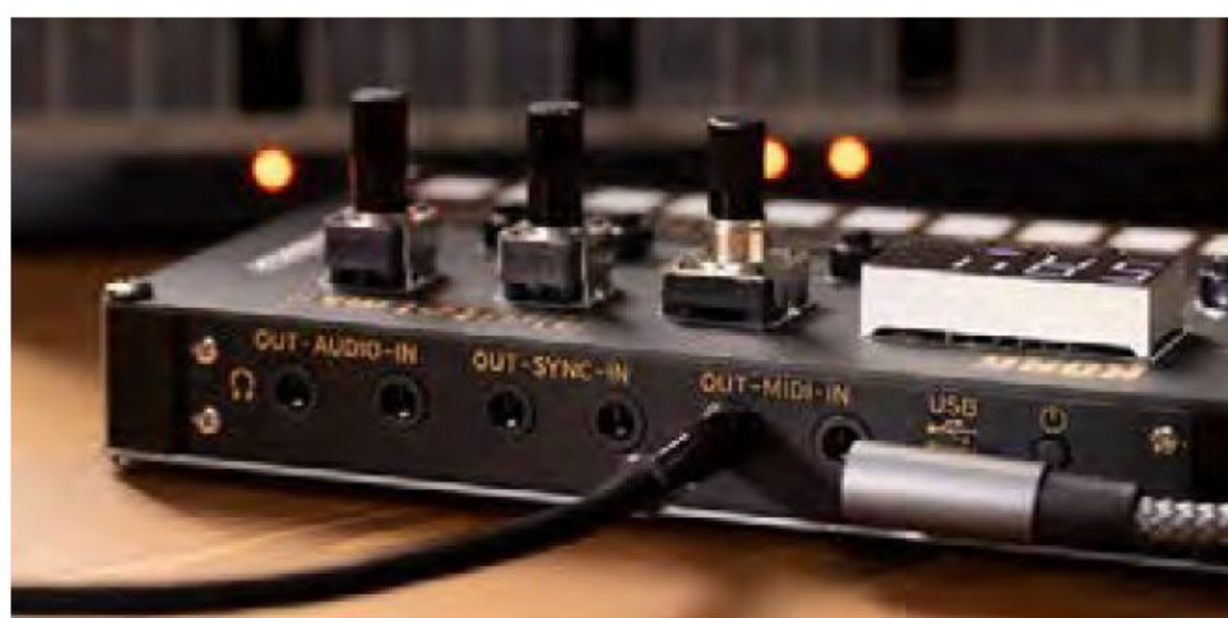
MIDI-Ausgang und USB-C Anschluss sind die sichtbaren Verbesserungen, intern wurde das Routing des Audioeingangs flexibler gestaltet.
