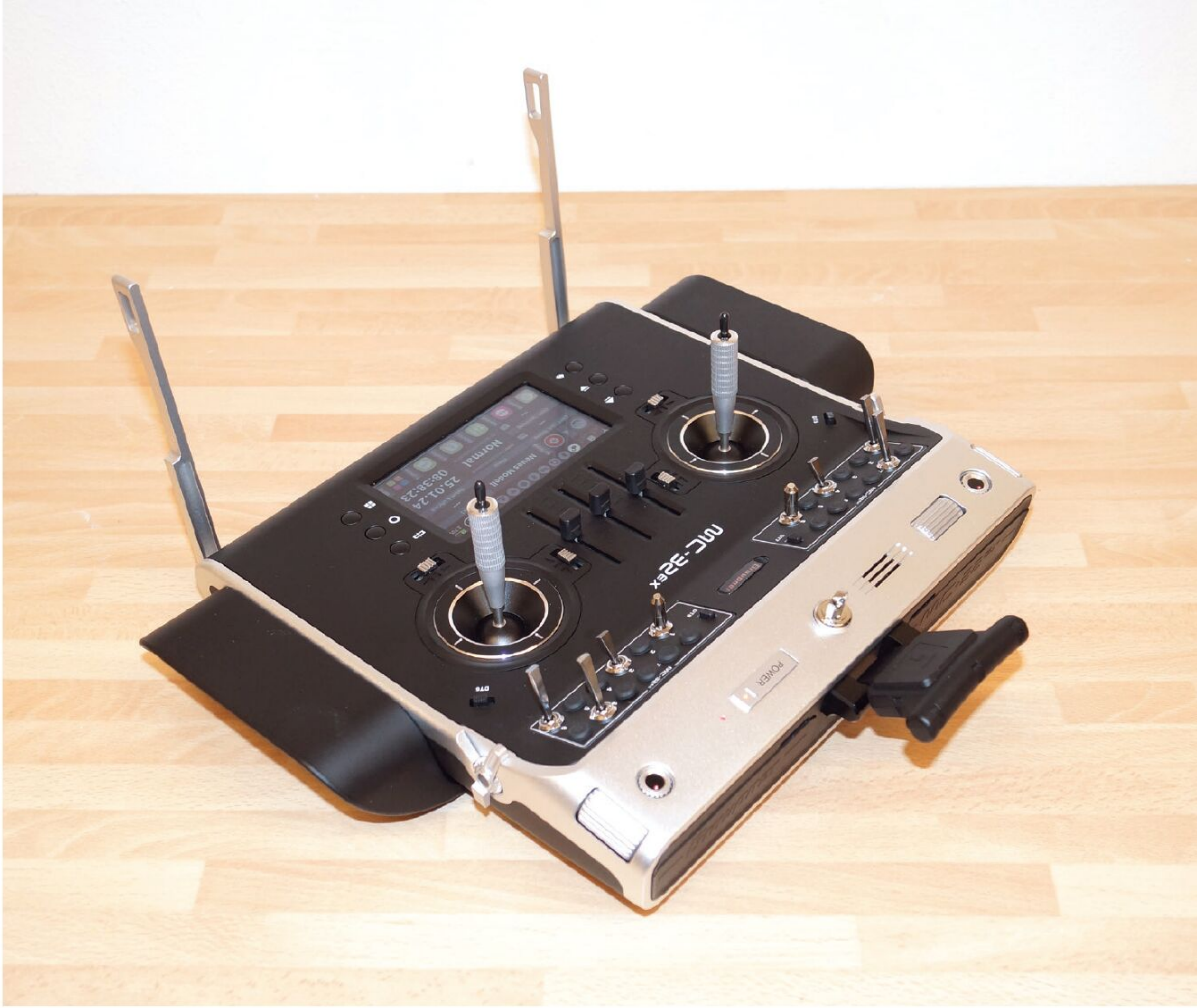
Die Aufhängungsbügel sind für einen einfachen Transport einklappbar. Die oberen Schalter-Paneele sind bereits mit jeweils vier Schaltern versehen und während des Fliegens mit den Fingern gut erreichbar. Zusätzlich finden sich noch verteilt Taster zur Trimmung beliebiger Funktionen. Die Antenne lässt sich um 180° schwenken. Dies ermöglicht eine perfekte Abstrahlung in jede Richtung.
