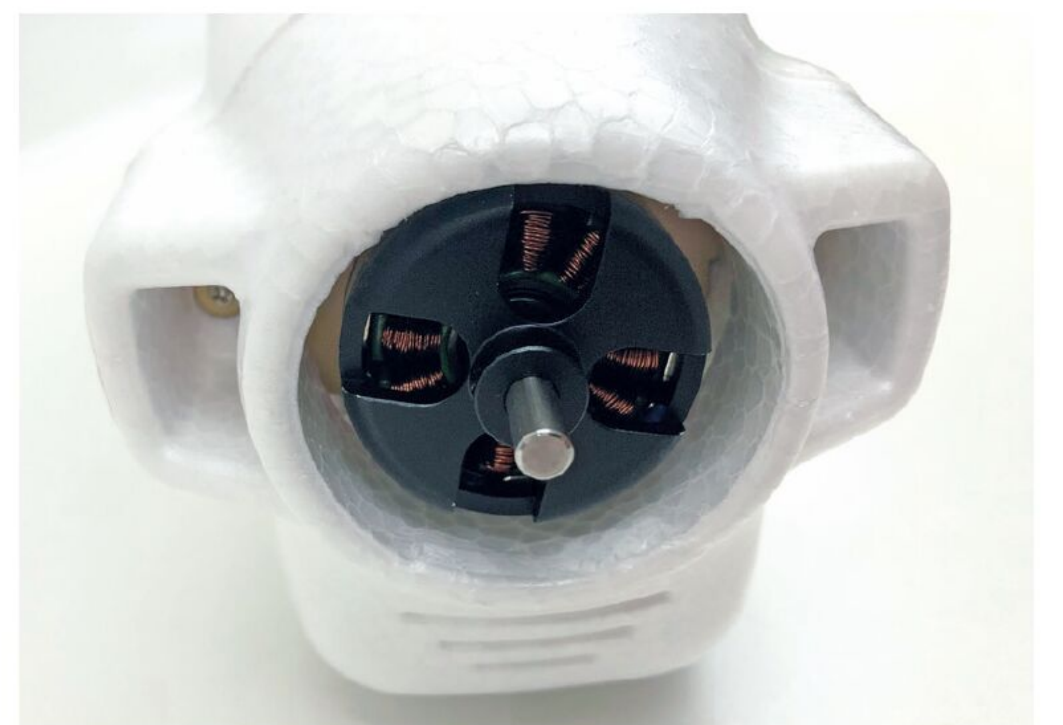
Der 880-KV-Motor ist ebenfalls fertig montiert. Die seitlichen Lufthutzen sorgen für gute Kühlung.
