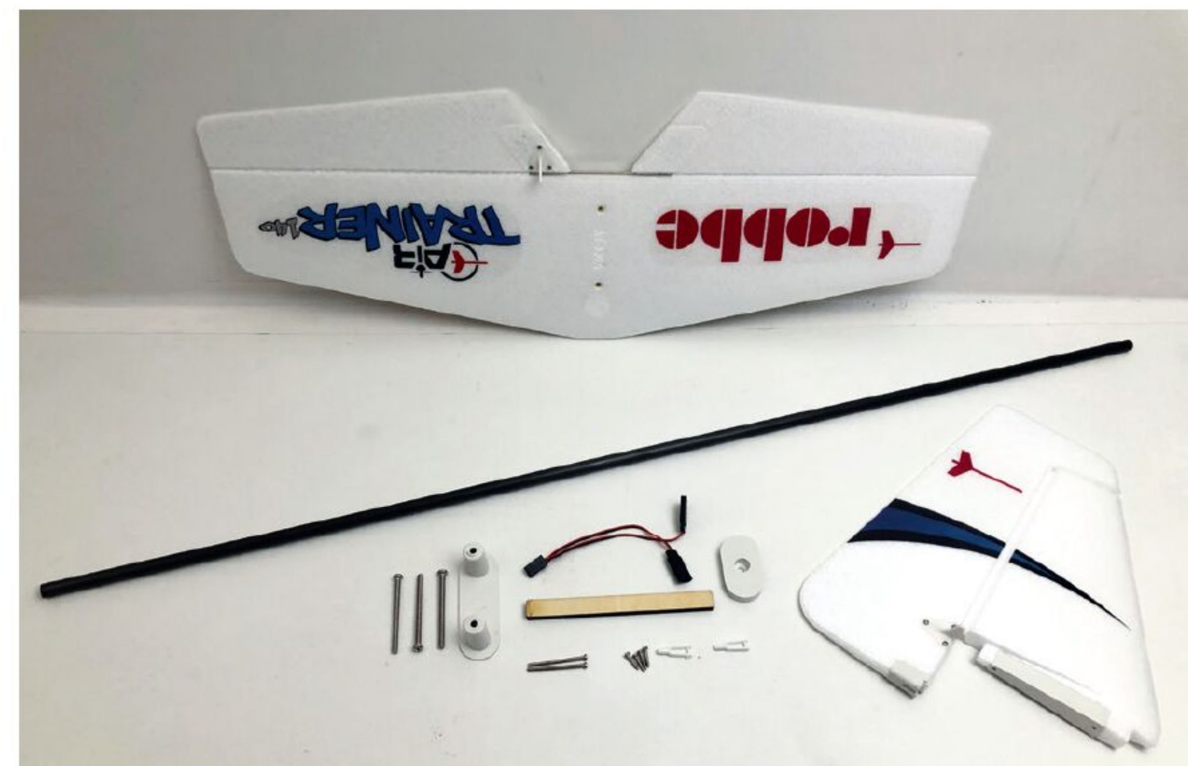
Höhen-, Seitenleitwerk, Flächenverbinder und noch ein paar Schrauben – mehr muss nicht montiert werden, um den Air Trainer flugfertig zu machen.
