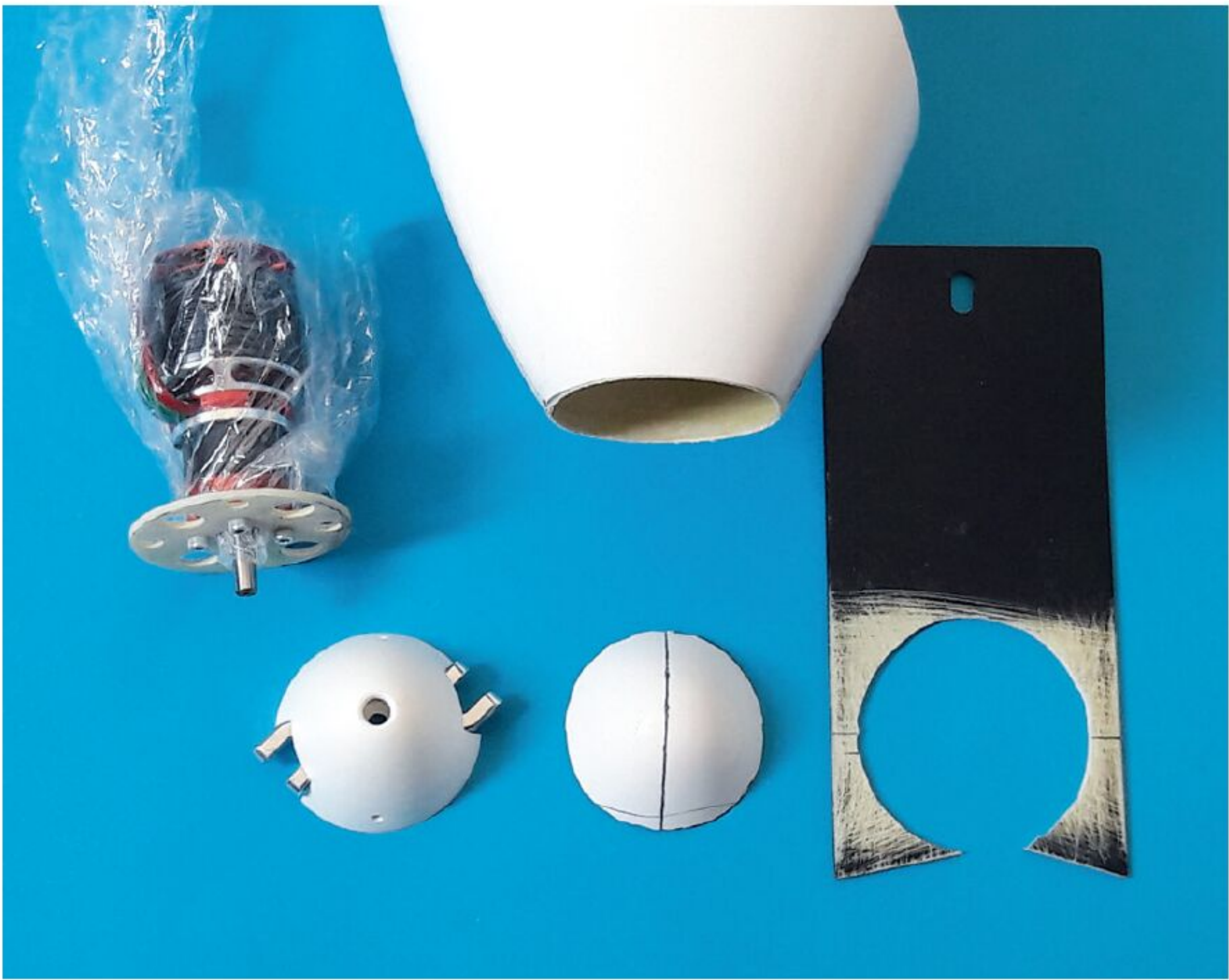
Bei einer Elektrifizierung kann man die Variante mit Spinnerlösung wählen. Dazu muss beim Kevlarrumpf die Nase mühsam zurechtgeschliffen werden. Die Kühlluft erhält der Antrieb durch den Spinner.
