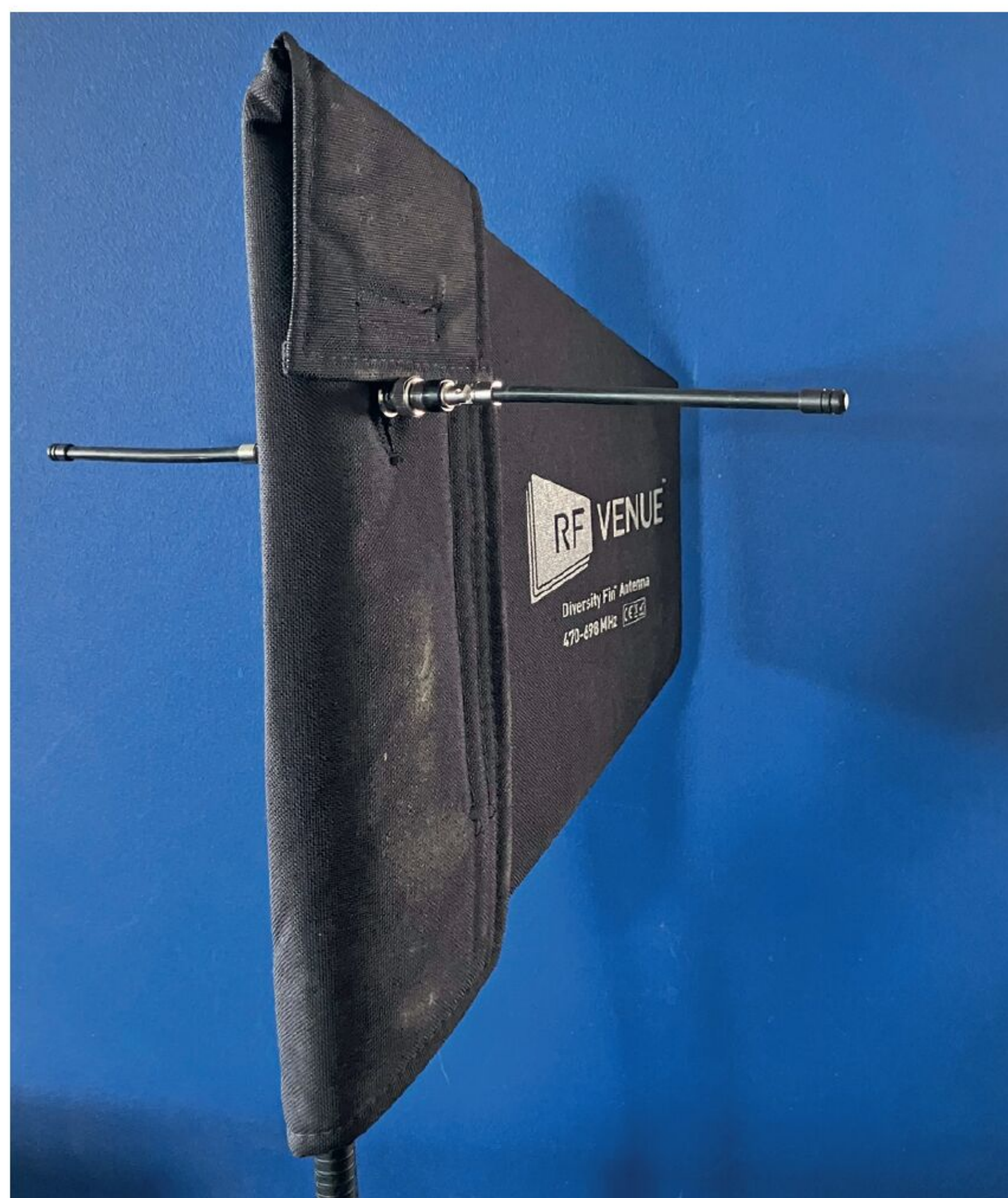
Doppelantenne: lambda/2-Dipol und passive LogPer Richtantenne in einem. Beide Polarisationssebenen, Rund- und Richtstrahler kombiniert. Der Bezug muss zum Betrieb nicht abgenommen werden. Die beiden Koax-Ausgänge zu den Empfängern sind so vor Umwelteinflüssen geschützt.
