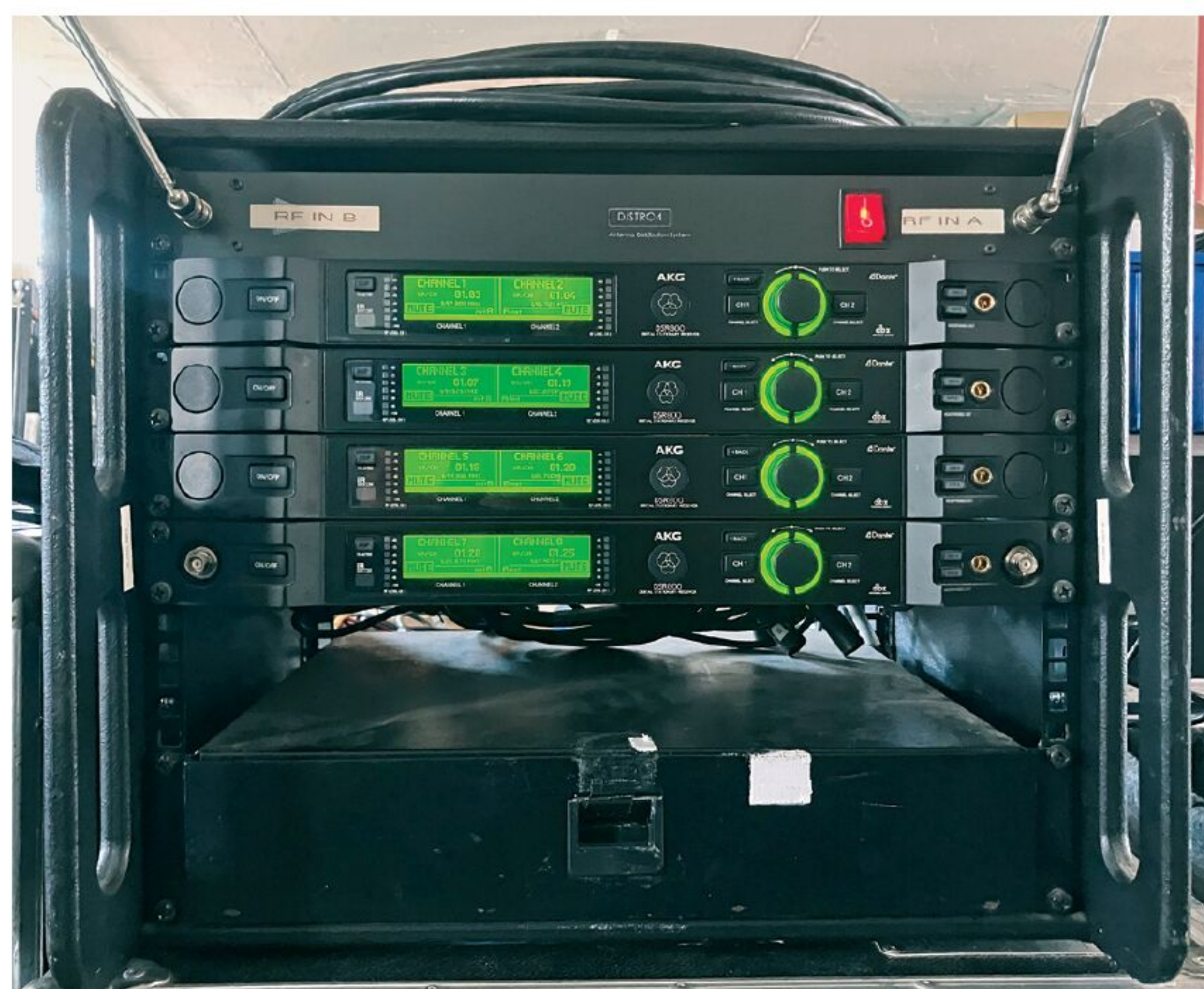
8 Kanal AKG Funkrack mit RF Venue Splitter und vermeintlich »schlechten« \lambda/4 Original-Antennen. Genau so ist es seit Jahren in Betrieb. Foto: Michael Bernhard
