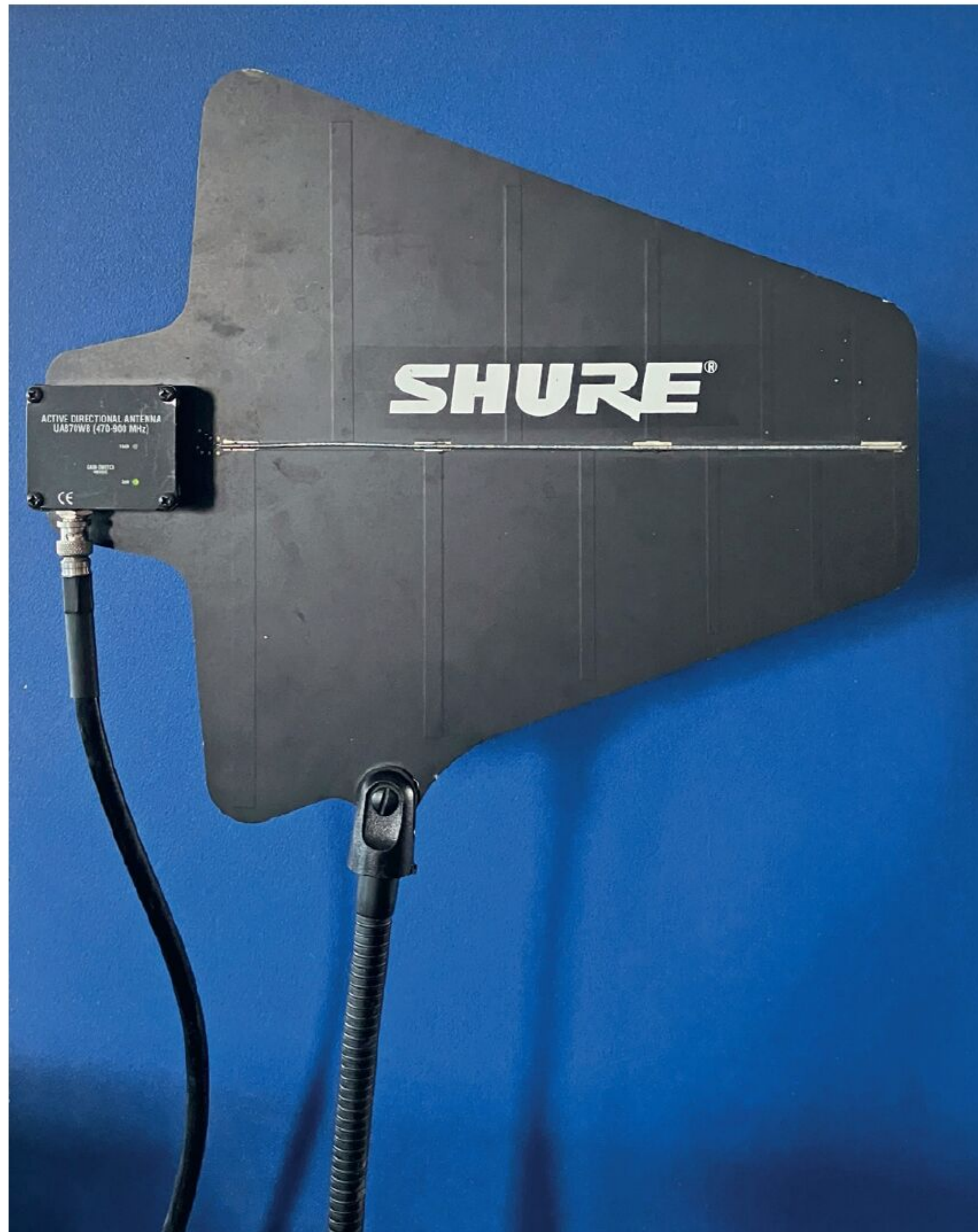
Shure LogPer Richtantenne (eine breitbandigere Abwandlung einer Yagi). Aktivversion mit eingebautem Empfangsverstärker 3dB/10dB umschaltbar zur Kompensation langer Kabelstrecken. Nicht für IEM geeignet! Foto: Michael Bernhard
