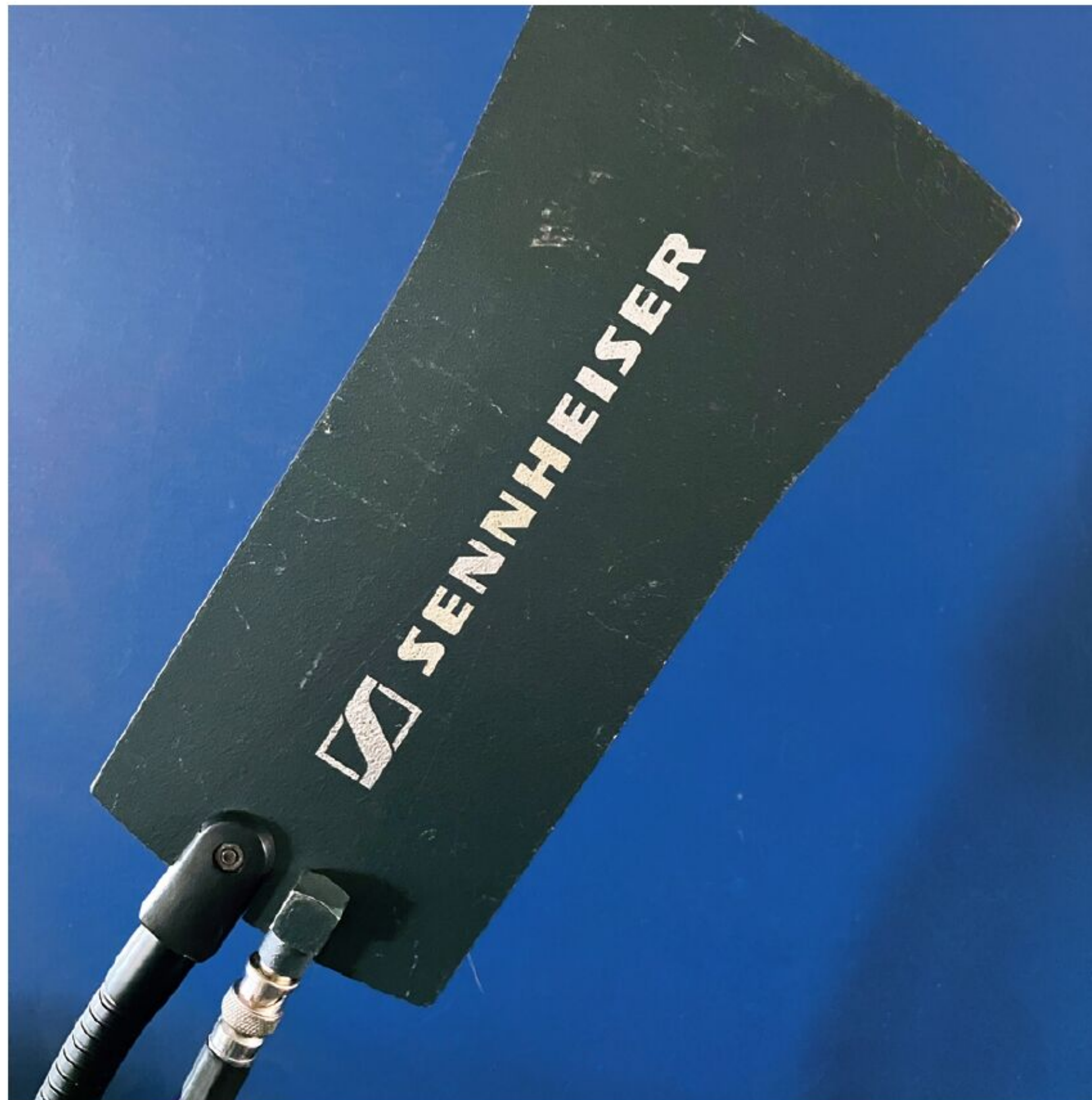
Sennheiser Rundstrahler für Stativmontage – vermutlich ein \lambda/2 -Sperrtopf (endgespeister Dipol). Das dicke Koaxkabel ist grenzwertig, da hohe Kräfte auf die Steckverbinder wirken.
