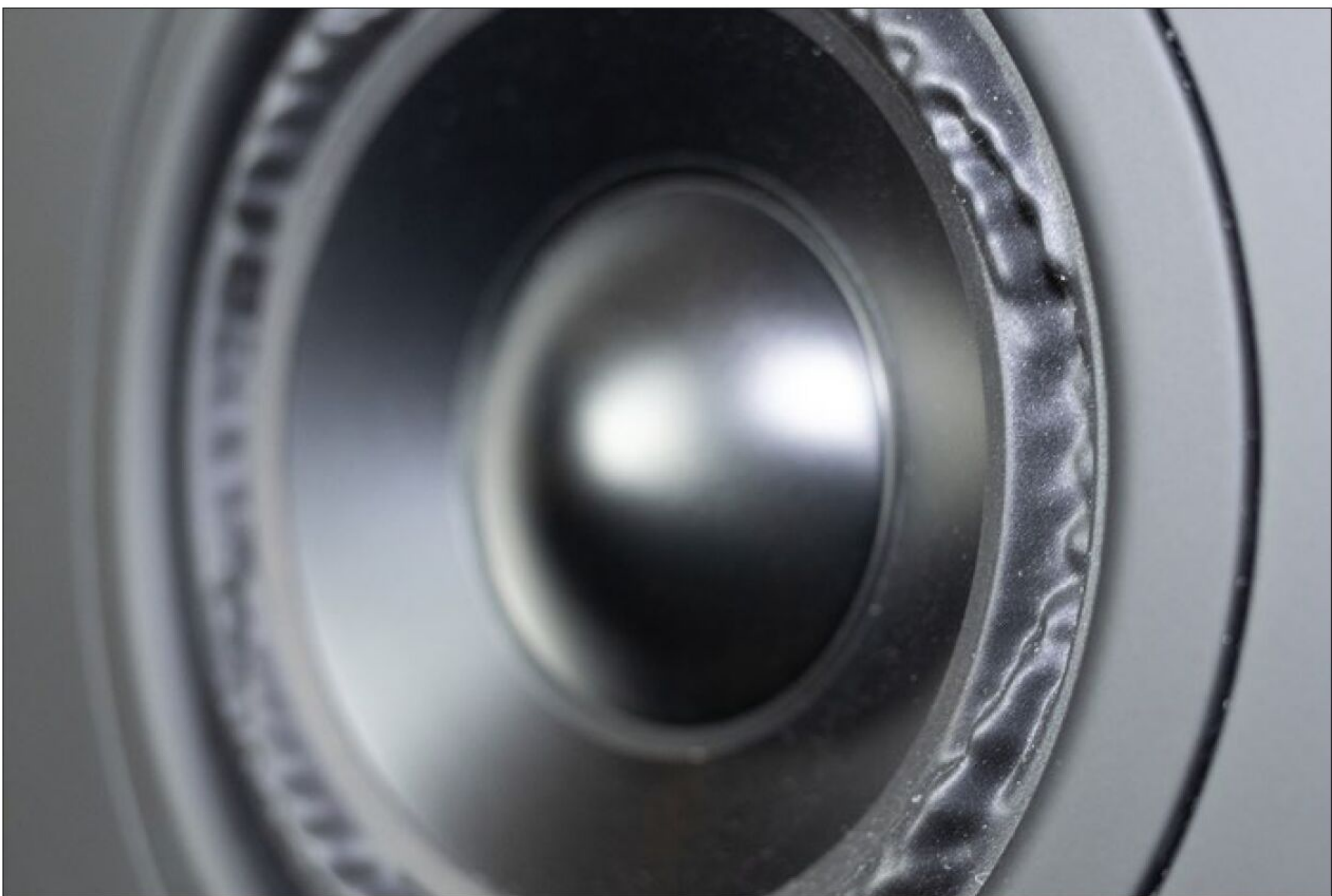
Zwar sieht die Sicke wie „zerknautsch“ aus, aber diese Form ist so optimiert, dass die Wellen perfekt abgestrahlt werden können
