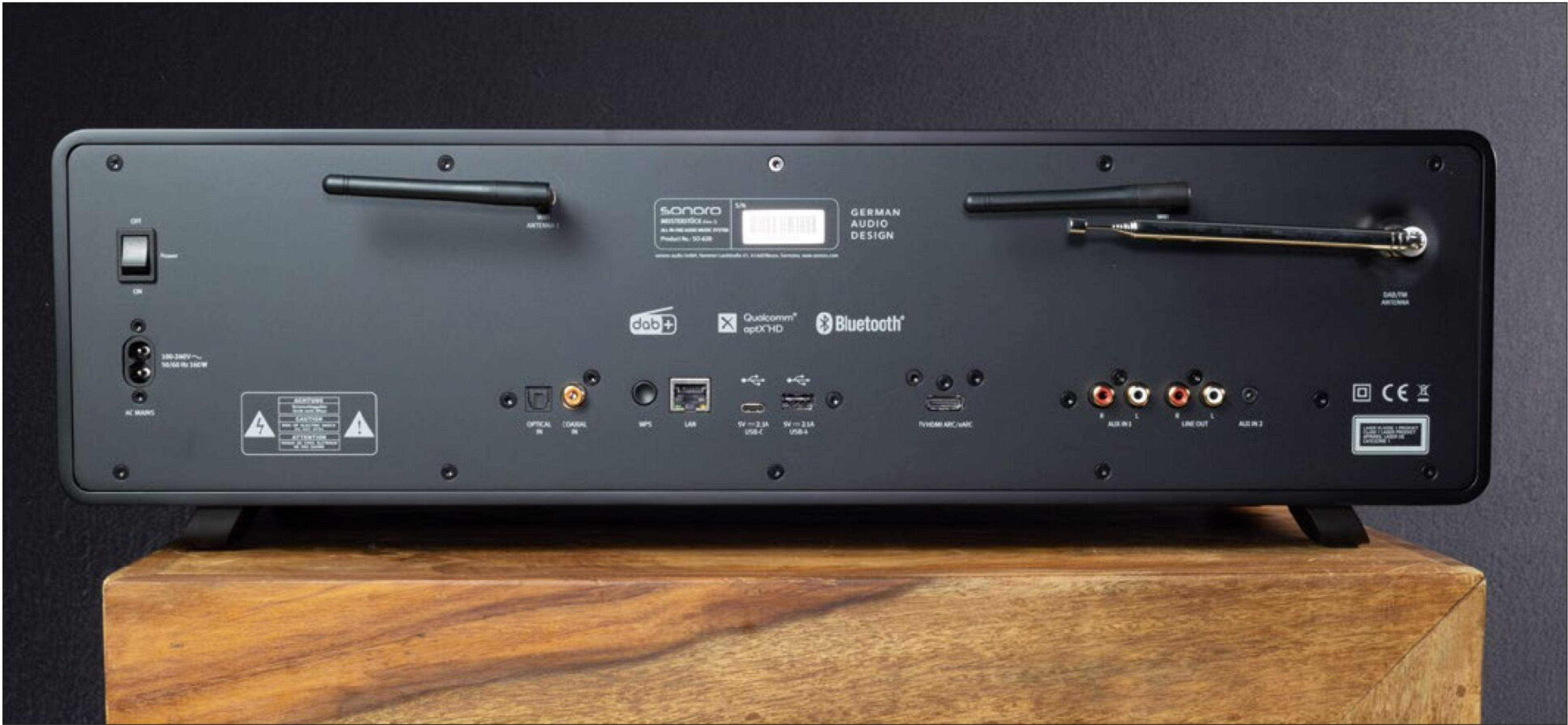
Der Kompaktanlage steht eine Auswahl an analogen und digitalen Eingängen zur Verfügung. Sogar ein Line-Out ist an Bord und der LAN-Anschluss ist praktisch für alle User, die das sehr gute WLAN-Modul nicht nutzen wollen
