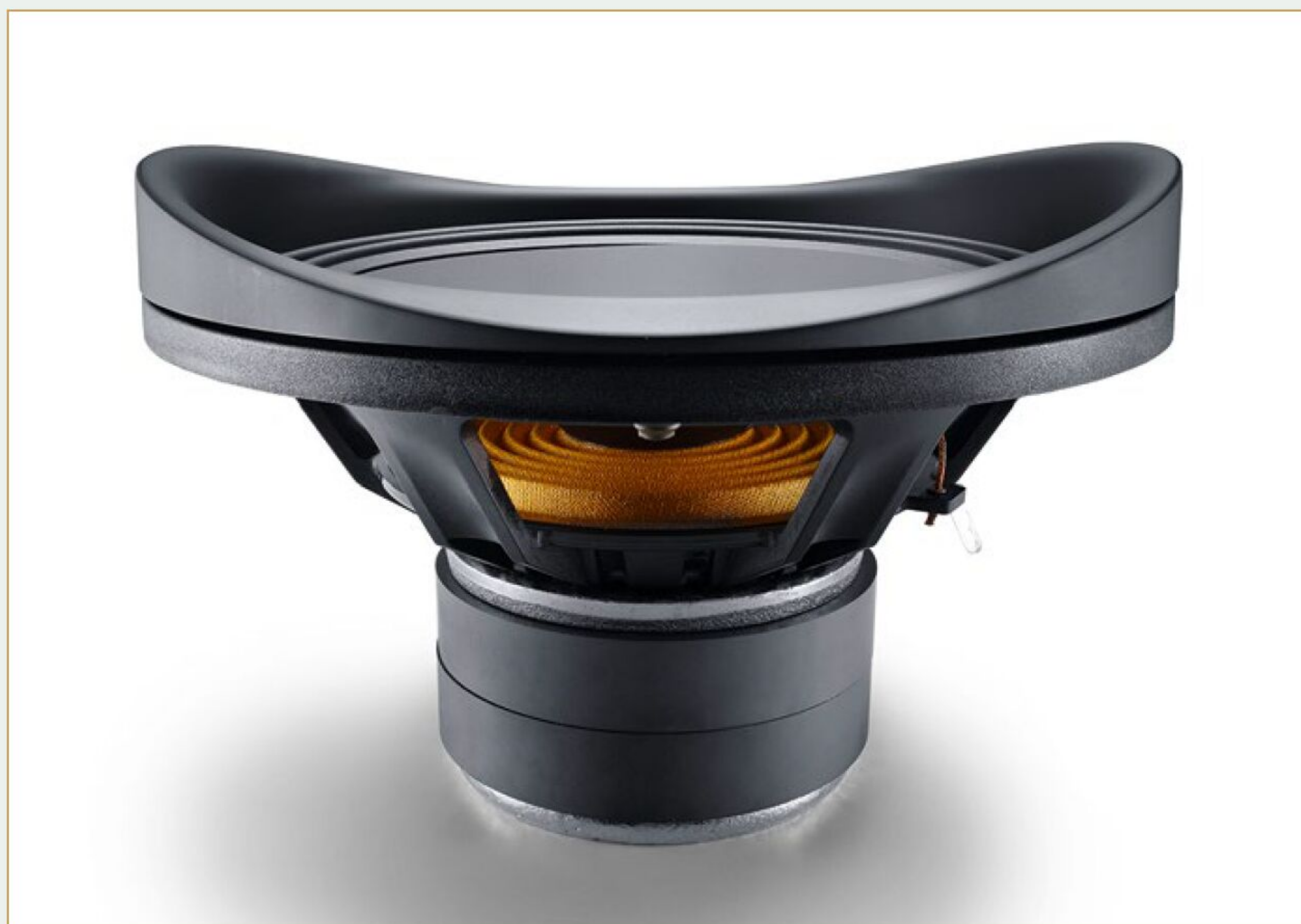
Der resonanzarme Abdeckring von Tief- und Mitteltönern fungiert obendrein als Wave Guide und sorgt somit für ein optimiertes Abstrahlverhalten der Chassis
