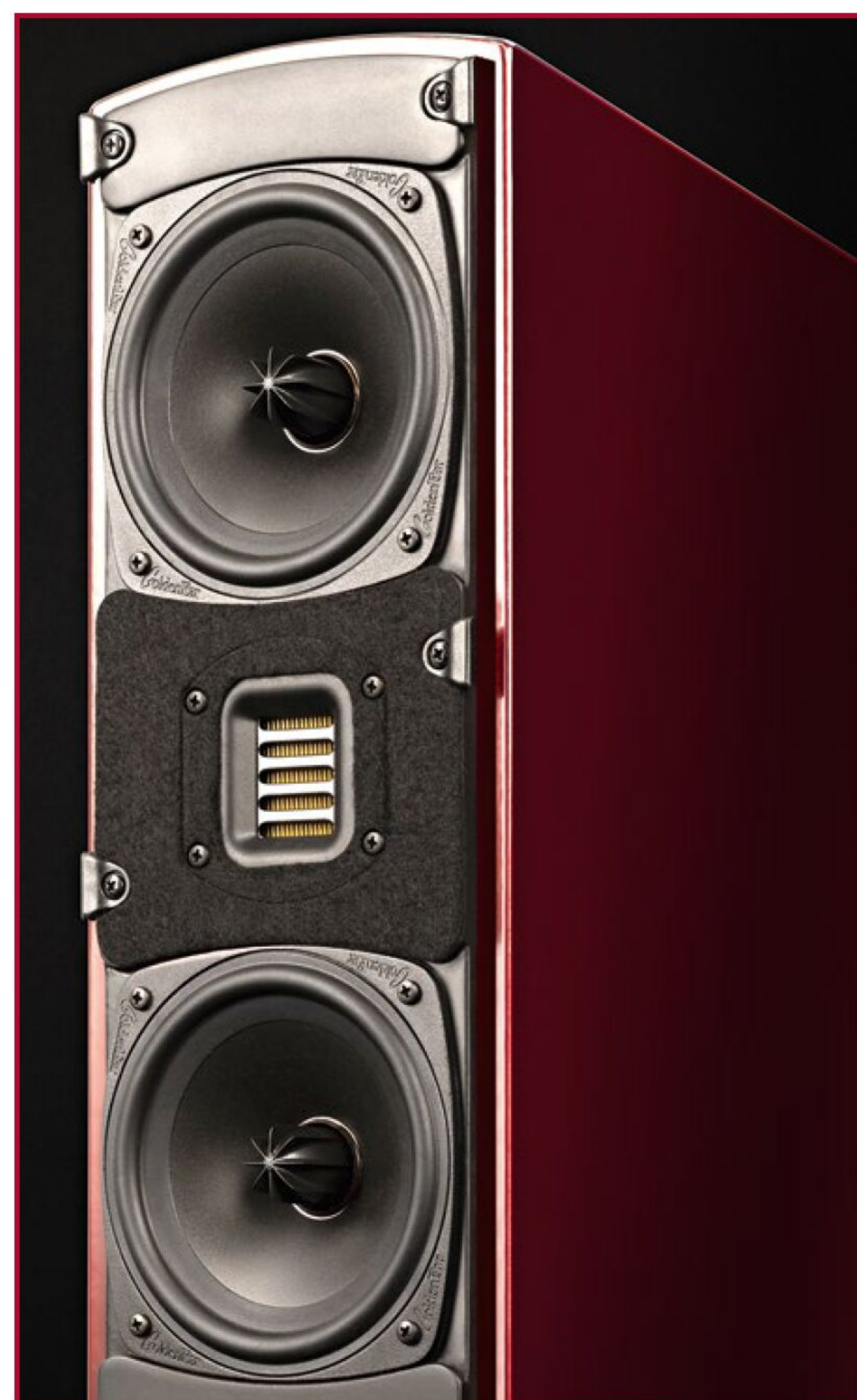
Der AMT-Hochtöner sitzt in einer Montageplatte mit Wollfilz, dadurch werden Beugungs- und Rückprall-Verzerrungen vermindert
