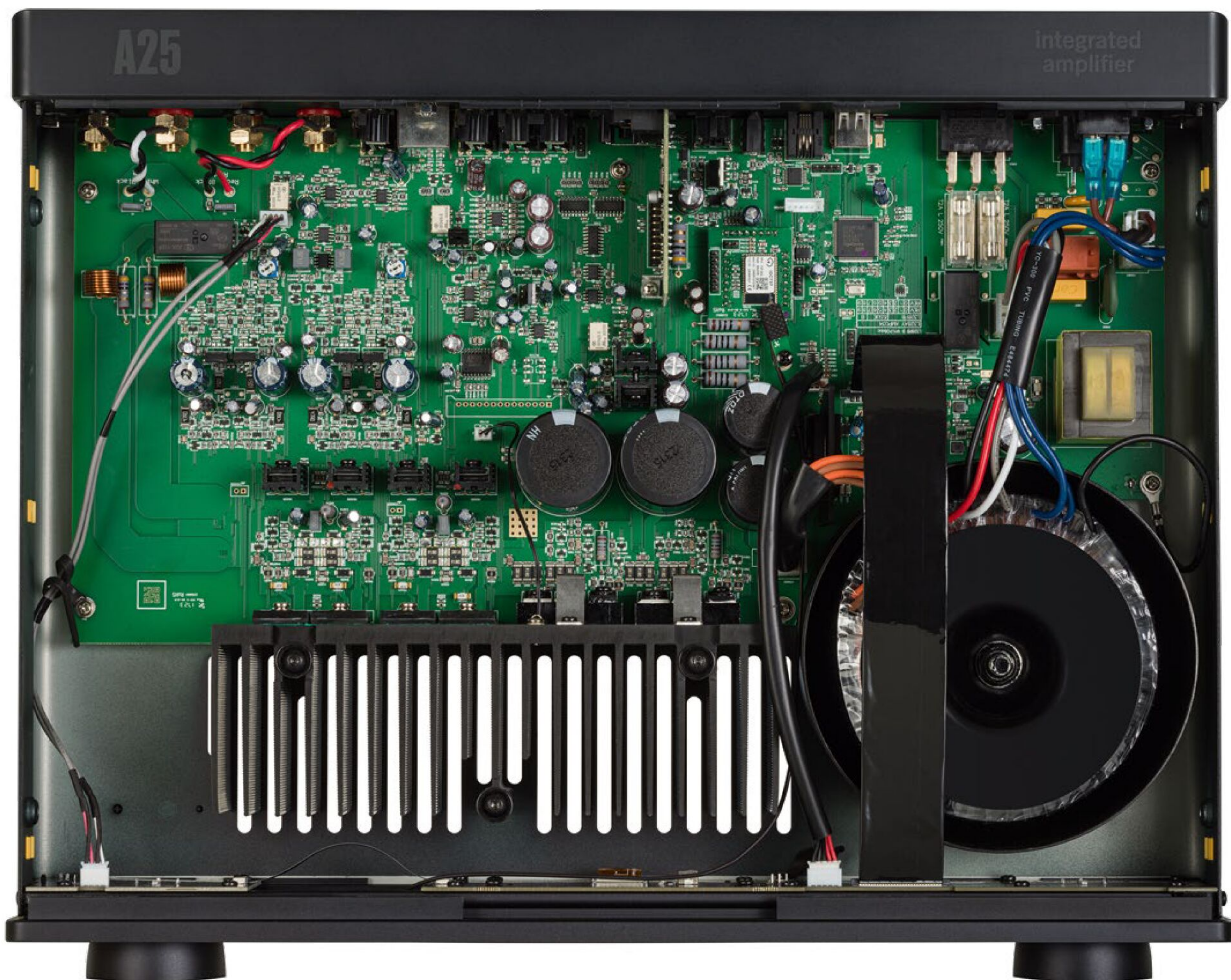
Der Radia A25 setzt auf Class G, das bedeutet, dass er zwischen mehreren Versorgungsspannungen hin und her schaltet, je nachdem, was an Leistung gebraucht wird
