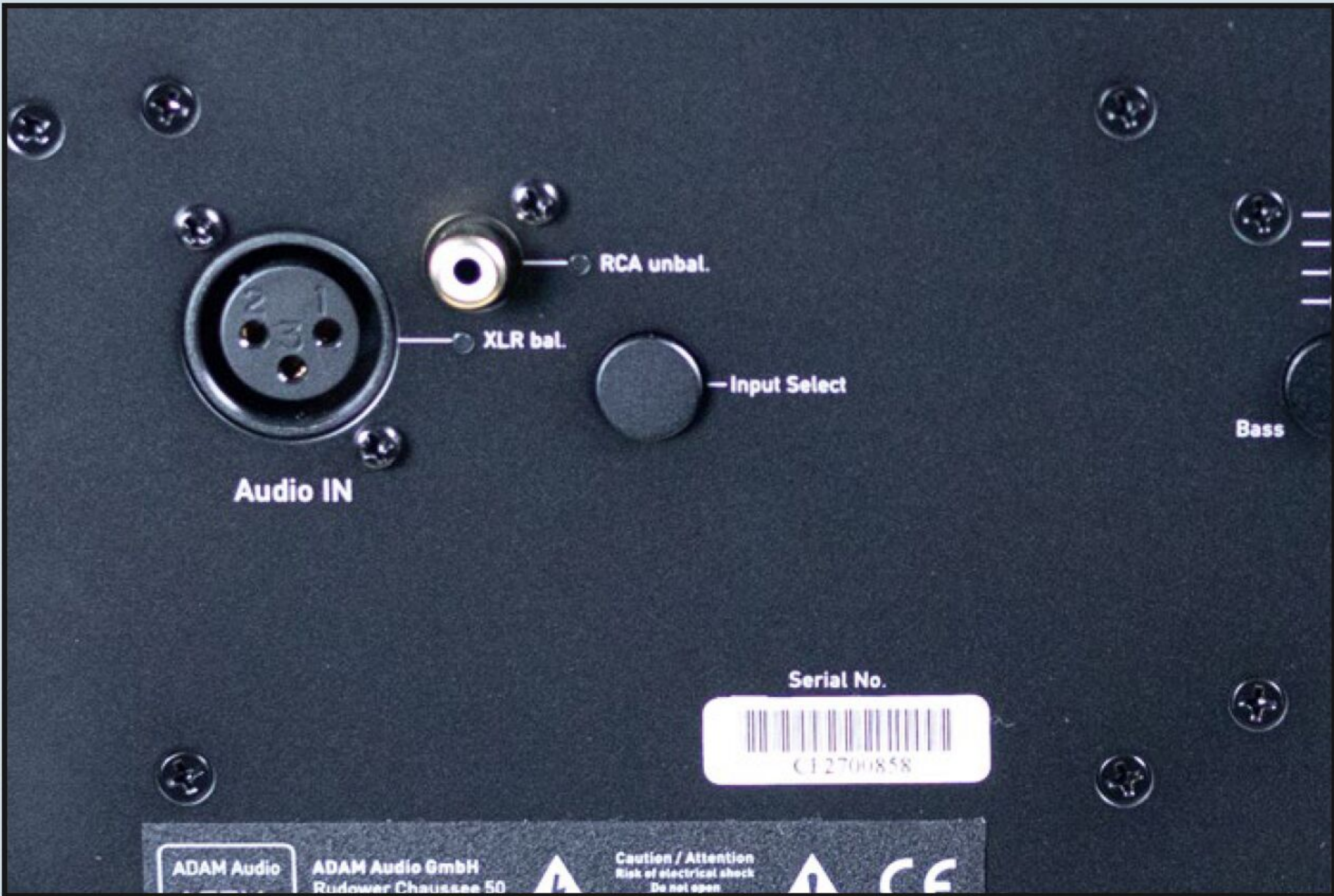
Der A77H bietet neben XLR zur symmetrischen Signalübertragung auch Cinch. Letzteres ist bekanntlich unsymmetrisch
