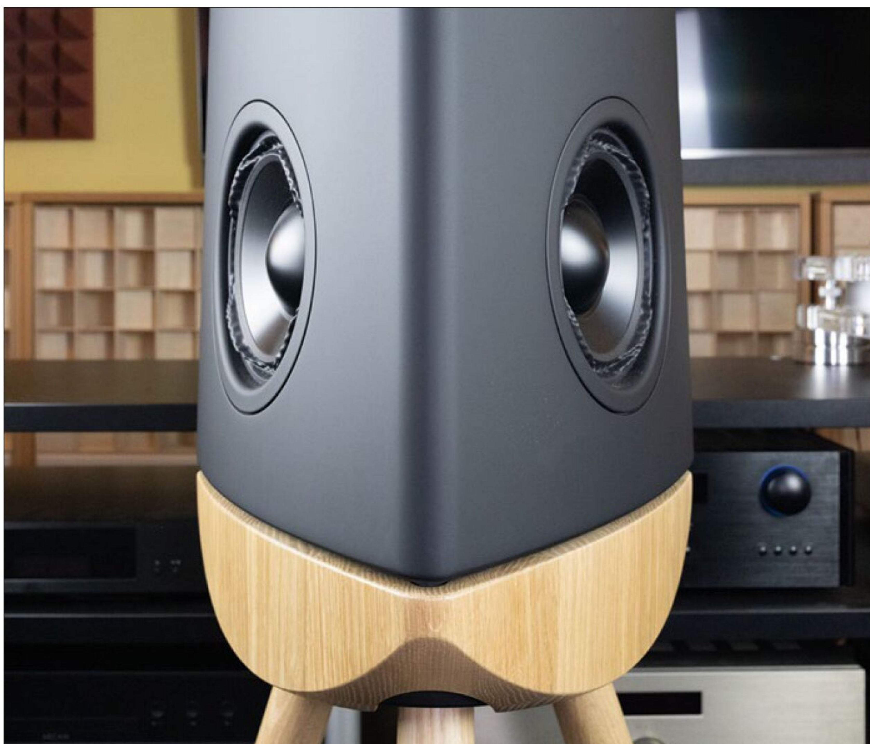
Auf der linken und rechten Rückseite sitzt jeweils ein Passivradiator. Er erlaubt einen sehr kraftvollen Bass bei relativ kleinem Gehäusevolumen
