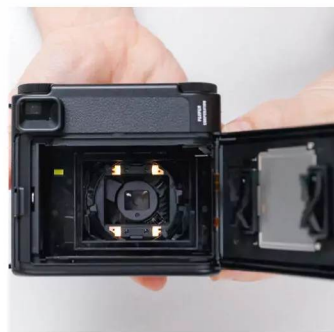
Über vier Lichter im Inneren kommen die Farbeffekte zustande.
