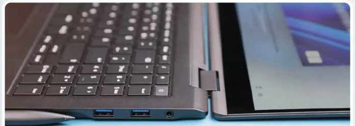
Auf der rechten Seite des Gram-Notebooks befinden sich zwei USB-A-Schnittstellen zum Anschließen von Maus, Tastatur oder Festplatte. Daneben dockt der Stylus Pen per Magnetmechanismus an und lädt gleichzeitig.
