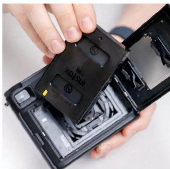
Den Film legt man auf der Rückseite ein. Darüber befindet sich der Akku.
