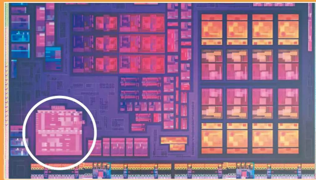
Die zwei getesteten AMD-Phoenix-CPU haben eine KI-Einheit (Kreis).
