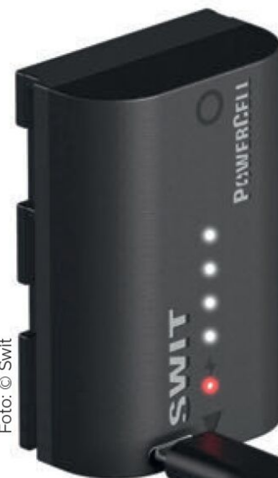
Der USB-C-Anschluss, hier bei der Swit Powercell für Canon, befindet sich direkt am Akku. Durch den Wegfall eines externen Ladegeräts wird das Aufladen flexibler.
