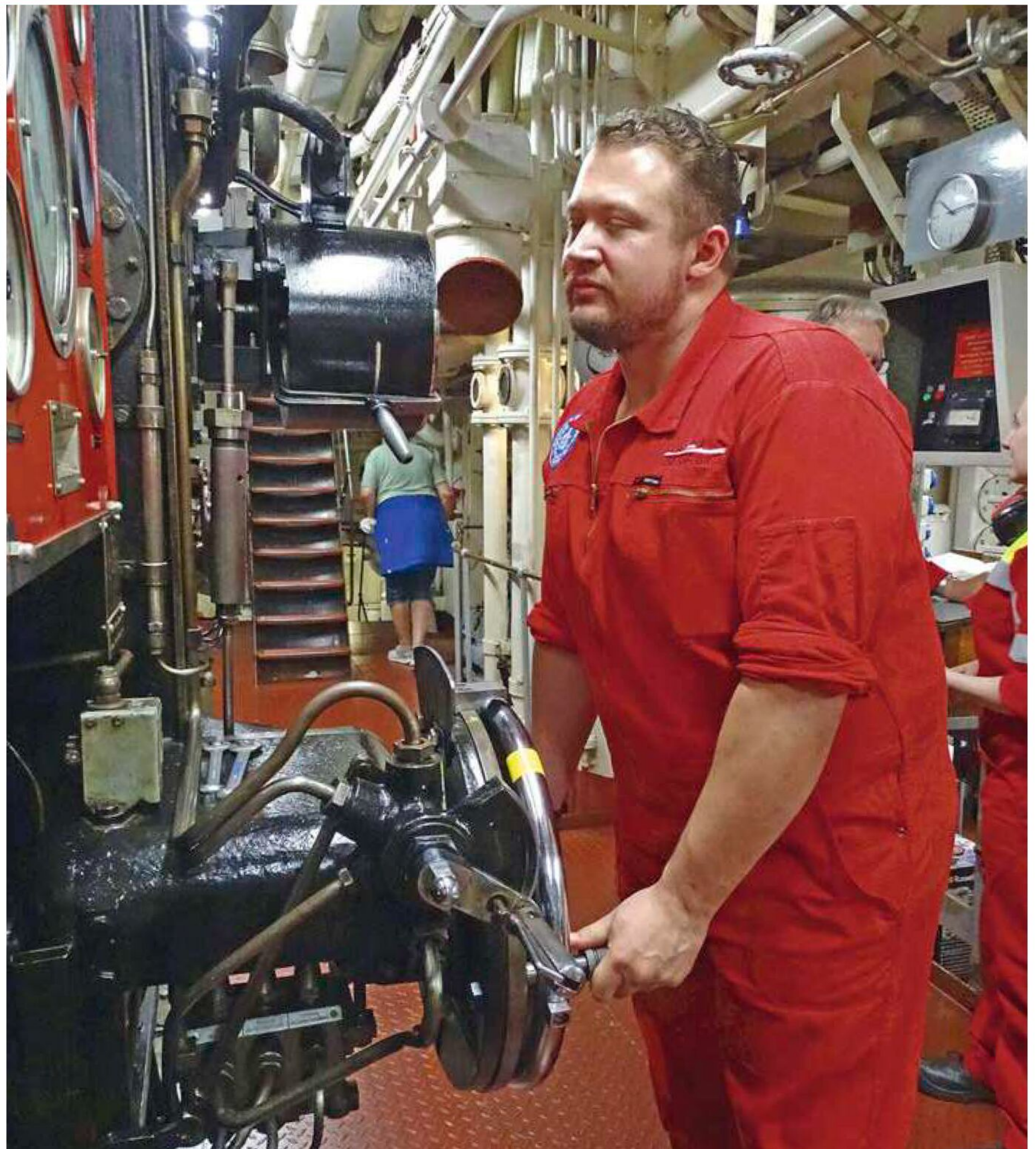
OHNE GEHT'S NICHT: Christian Blaauw, einer der vielen Ehrenamtlichen an Bord, beim Einstellen der Fahrtstufe per Manöverhandrad
