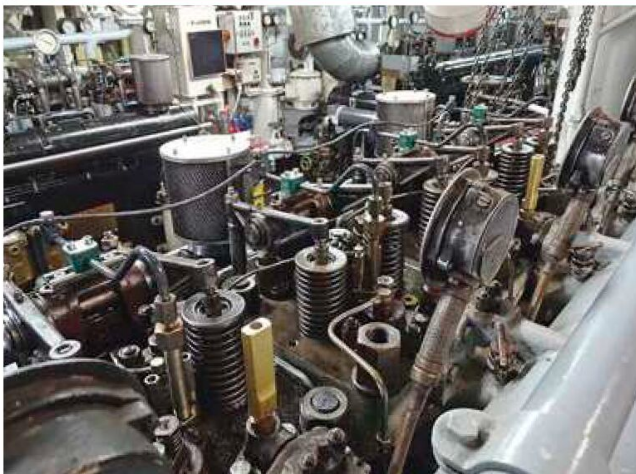
UNTERSTÜTZUNG: Die Hilfsdiesel der Cap San Diego werden für die Erzeugung des elektrischen Stroms benötigt
