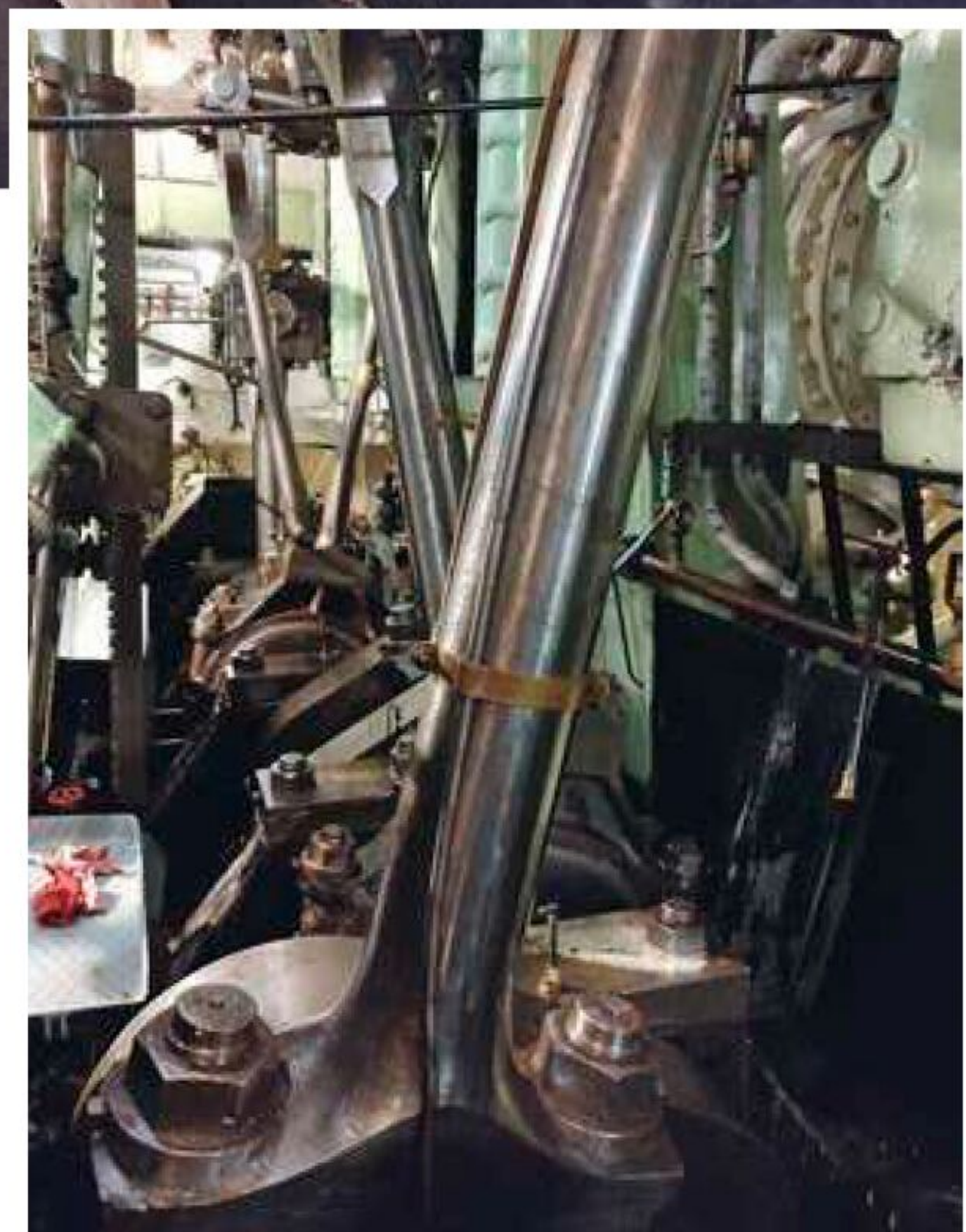
EINE BESONDERHEIT AUF NORD- UND OSTSEE: Die Dreifachexpansions-Dampfmaschine
