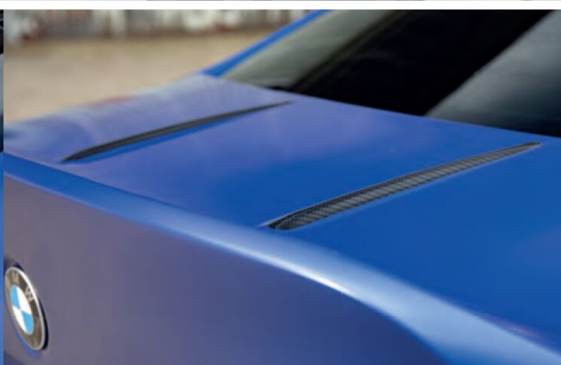
Der Alpha-N-Heckdeckel mit CSL-Ducktail zeigt sein Carbon-Material sowohl obenauf als auch von unten.
